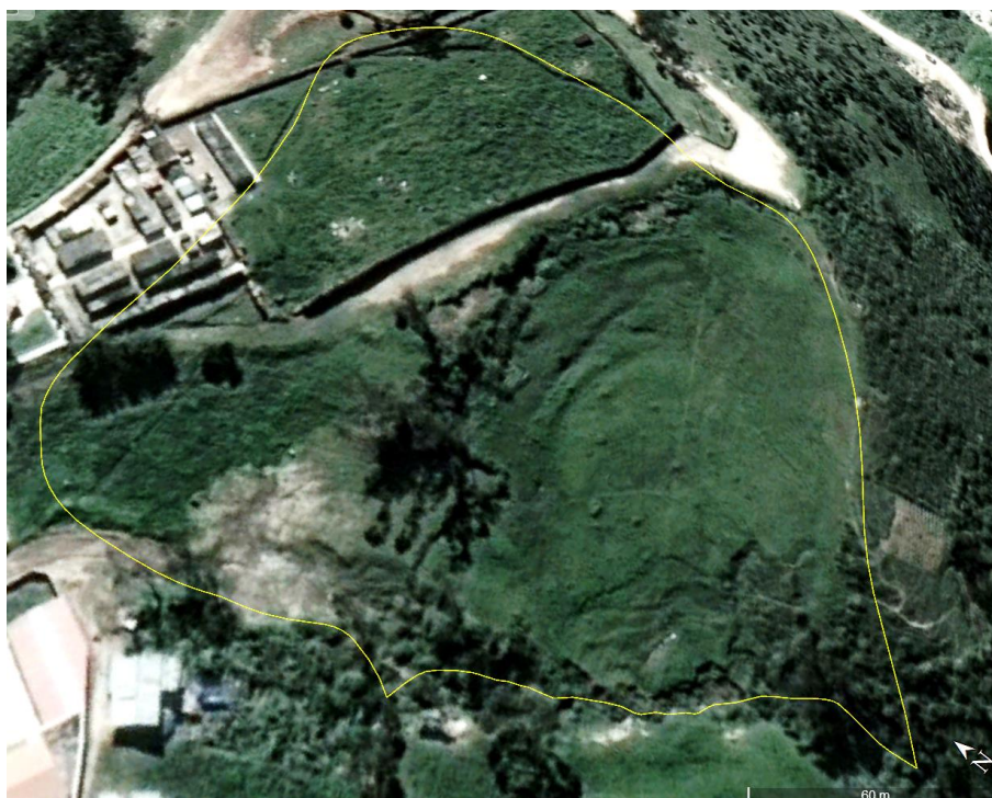
Figura 10. Imagen satelital de mayo del 2010, donde se muestra ausencia de viviendas en el cuerpo del deslizamiento (delimitado en línea amarilla).
