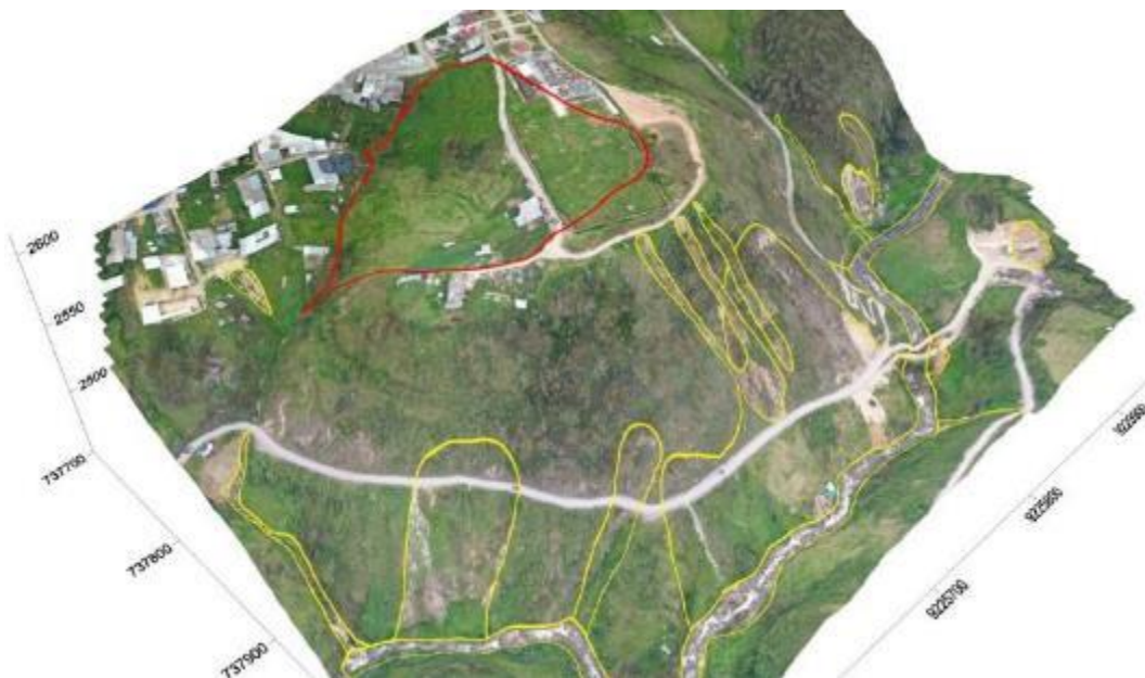
Figura 8. Modelo 3D del cementerio San Juan, el deslizamiento inactivo latente está delimitado en línea roja y los demás peligros en línea amarilla.
