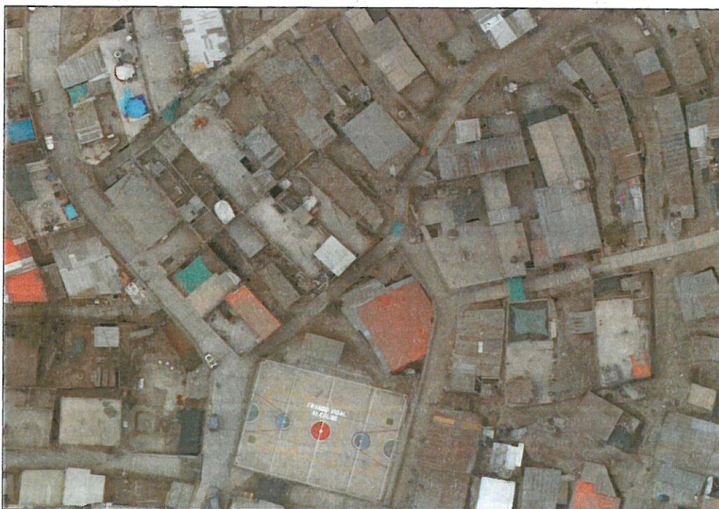
Figura 15: Las viviendas de albañilería no cuentan con área libre; más a lo contrario, el 100% del lote es área techada. (Las viviendas no tienen ventilación ni iluminación natural).
