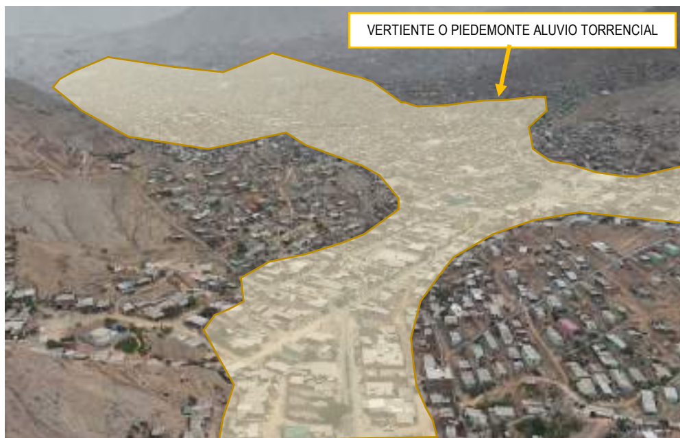
Vertiente o piedemonte aluvio torrencial, que son antiguos depósitos donde actualmente se han asentado viviendas
