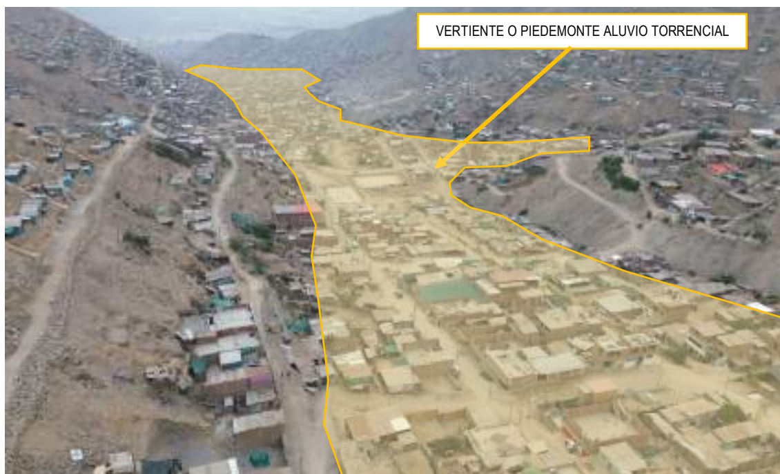
Vertiente o piedemonte aluvio torrencial, que son antiguos depósitos donde actualmente se han asentado viviendas
