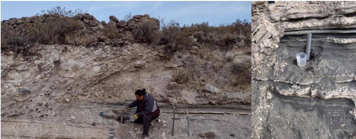
**Fotografías 3** Ensayo de infiltración de carga variable realizado en rocas del Centro Volcánico Hualca Hualca.
