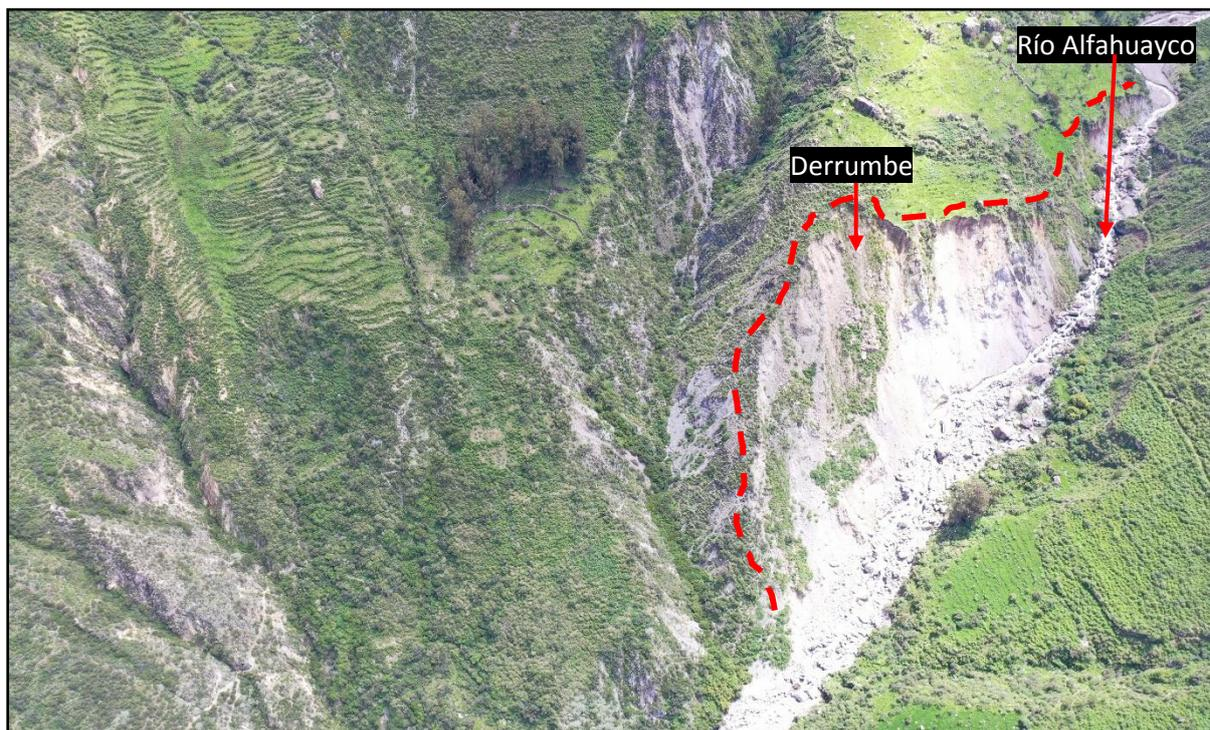
Figura 16. Derrumbe en el pie del deslizamiento Pomacocha.
