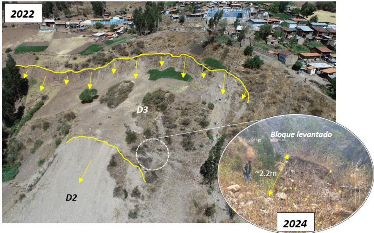
Figura 7. Para el 2024, la zona delimitada en círculo blanco se ha desplazado, formando un bloque basculado de 2.2 m, en dirección al río Huachecsa.
