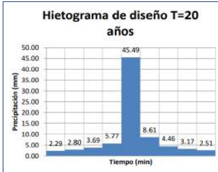
GRÁFICO 17. HIETOGAMA PARA 20 AÑOS DE PERIODO DE RETORNO. TOMADO DE DISEÑO HIDROLÓGICO - TESIS UNSA (2018).
