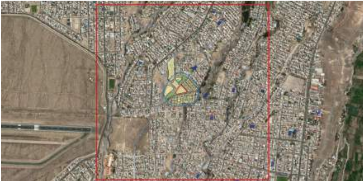
GRÁFICO 15. ÁREA DE INFLUENCIA DETERMINADA PARA VISUALIZAR LOS PELIGROS GEOLÓGICOS, BUFFER DE 100 METROS ALREDEDOR DEL TERRENO PROPUESTO GENERADO EN QGIS 3.36. ELABORACIÓN PROPIA.
