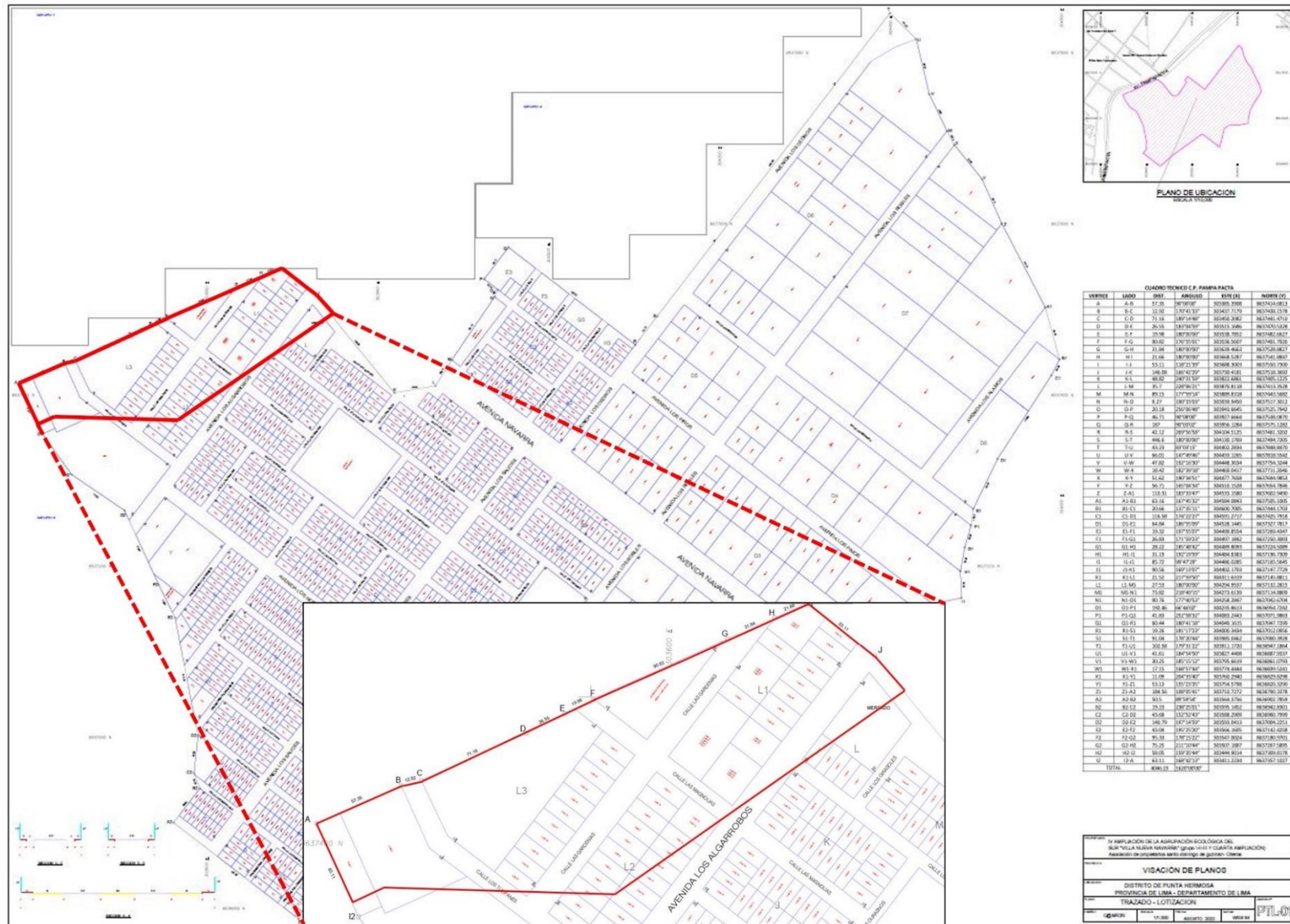
Figura 11. Plano de la Asoc. De Santo Domingo de Guzmán-Olleros. Se observa el área y lotes que se encuentran dentro de los límites de la faja marginal.
