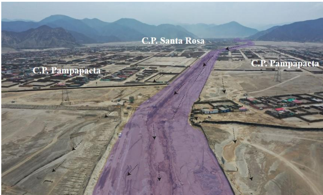
Figura 5. Recorrido del flujo de lodo desde la parte alta de la quebrada Malanche y su paso por los centros poblados Pampapacta y Santa Rosa. Imagen tomada por dron (2017). Tomado de Ingemmet, 2023.
