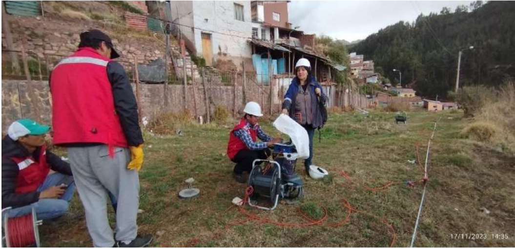
Fotografía 13: instalación Y Toma De Datos De tomografía eléctrica Te-02 Y refracción sísmica H-H' Fuente: Equipo técnico.
