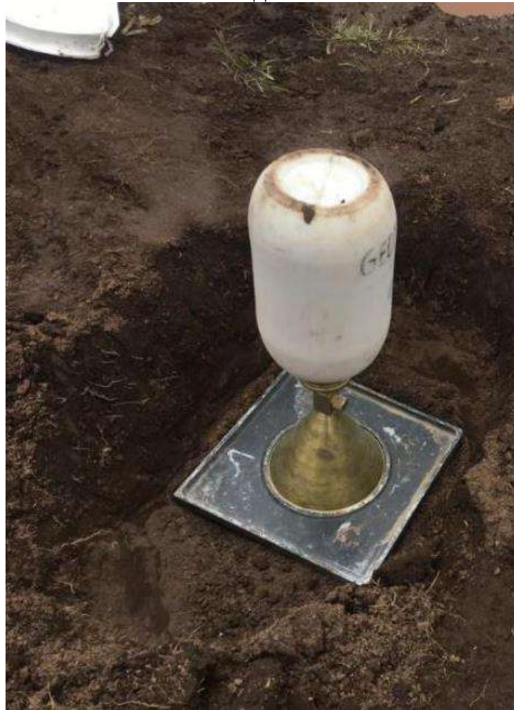
Fotografía 20: Ensayo de cono de arena para determinar la densidad relativa de los suelos
