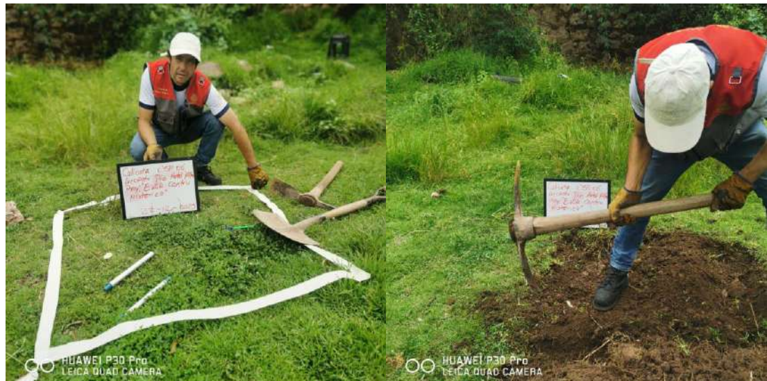
Fotografía 16: Calicata CSP06 Para La Estabilidad De Taludes C-C' Fuente: Equipo técnico.
