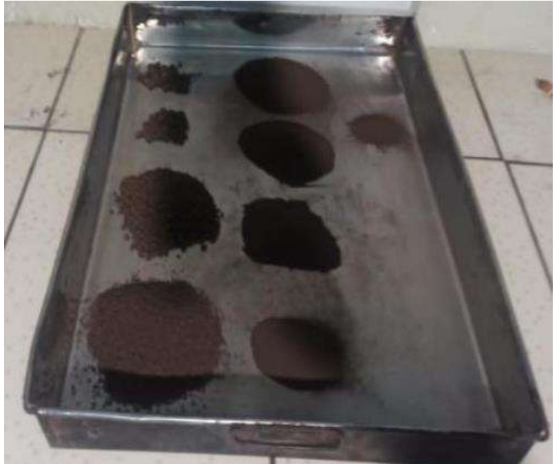
Fotografía 19: Resultados de una muestra que paso por el tamizado
