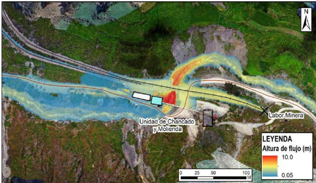
**Figura 33.** Se muestra el desborde del flujo a la altura Unidad de Chancado y Molienda; y como consecuencia la afectación de un tramo de la vía férrea, labor minera y tocha carrozable.
