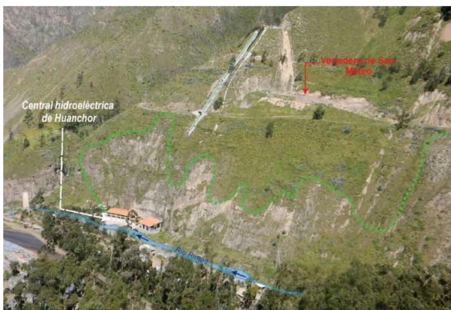
**Figura 24.** Vista en la margen derecha del río Rímac, donde se observan procesos de erosión de laderas (líneas discontinuas de color verde) entre las coordenadas UTM N 8697344, E 357479, con una cota de 2970 m s.n.m.
