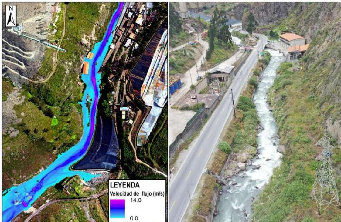
**Figura 38.** El modelo muestra la probable afectación de instalaciones e infraestructuras de la central hidroeléctrica de Huanchor, parte inferior del campamento de la Unidad Minera Coricancha y 680 m de la carretera central.
