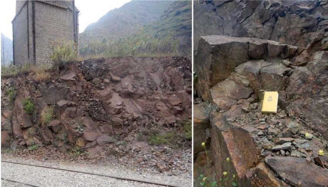
**Figura 5.** Afloramientos de andesitas masivas fracturadas y moderadamente meteorizadas. Vista de afloramiento ubicado al este de los depósitos de relaves 1-2.
