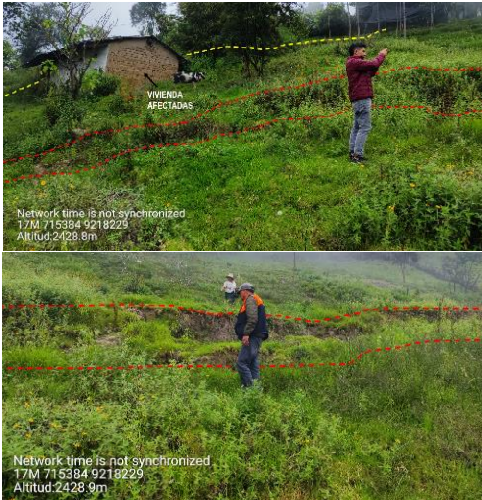
Figura 13. Vivienda dentro del cuerpo central del deslizamiento, donde se existe una vivienda afectada (arriba) y un escarpe secundario de hasta 1 m de salto vertical (abajo). El cuerpo principal del deslizamiento está delimitado en línea amarilla y el escarpe secundario en línea roja.
