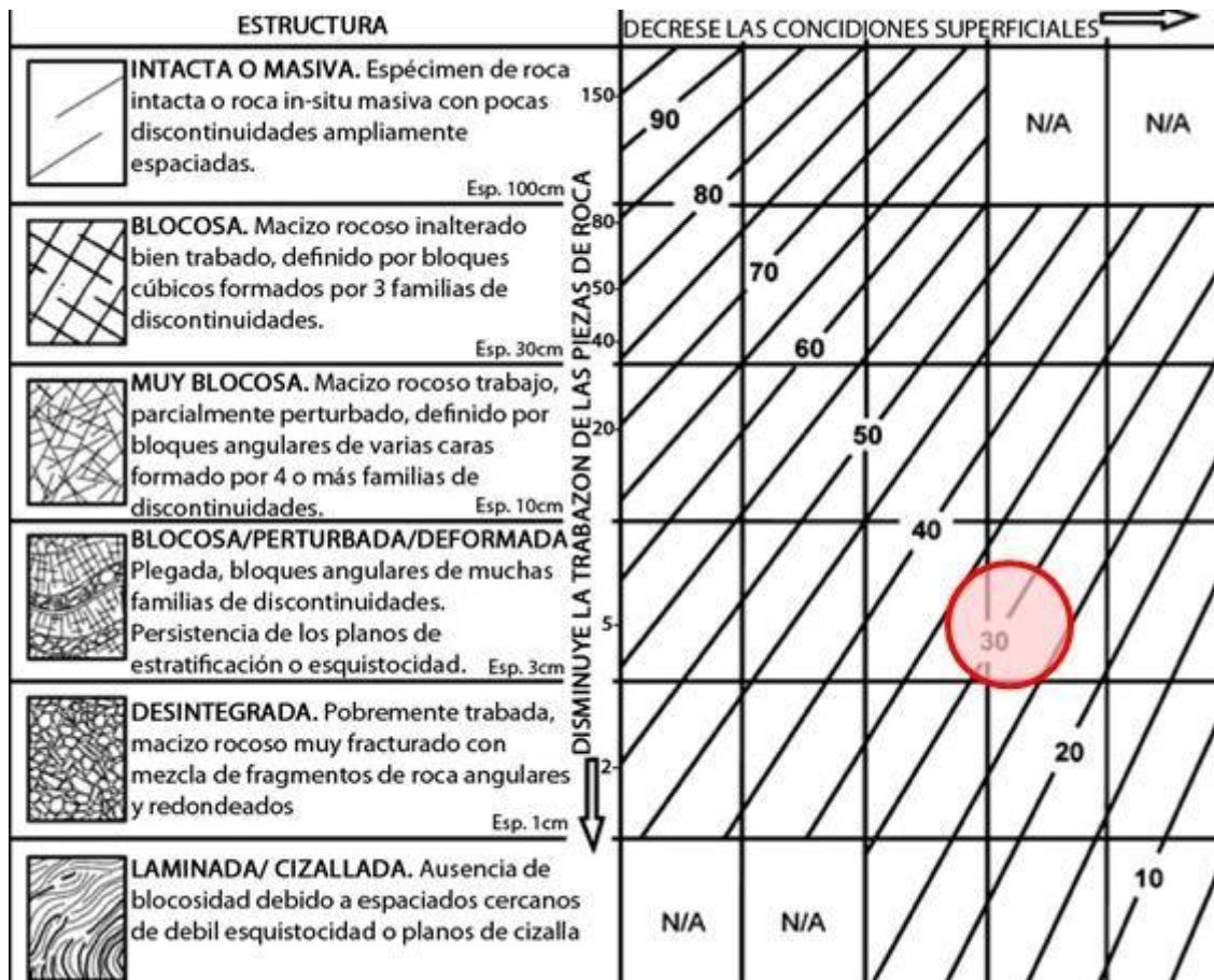
Figura 4. Estructura y calidad de las discontinuidades del macizo rocoso de la unidad Centro Volcánico Niepos - Evento 3, GSI promedio de entre 25 a 35. Fuente: Tabla del Índice Geológico de Resistencia GSI (Hoek, 2007).
