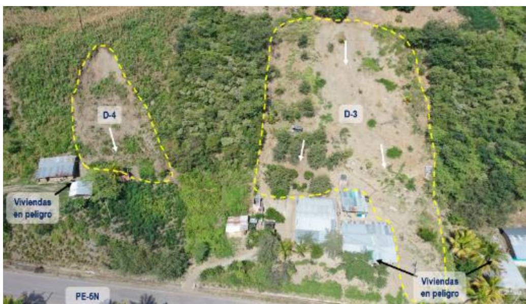
Figura 16. Deslizamiento D-3 y D-4 (delimitados en línea amarilla) al sureste de Puerto Naranjitos.
