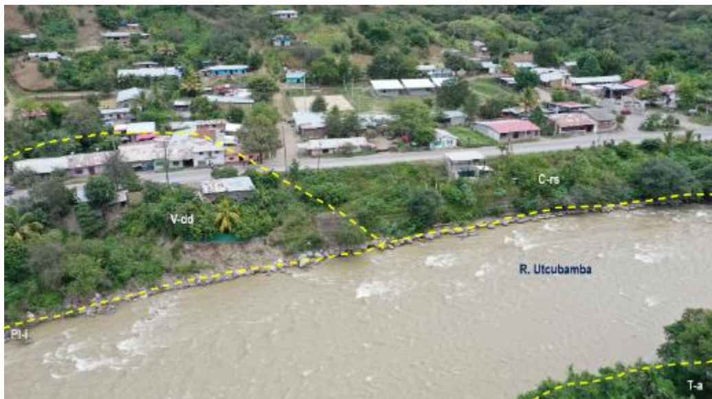
Figura 10. Geformas cartografiadas en la localidad de Salao: colina en roca sedimentaria (C-rs), vertiente con depósito de deslizamiento (V-dd), terraza aluvial (T-a) y planicie inundable (PI-i).
