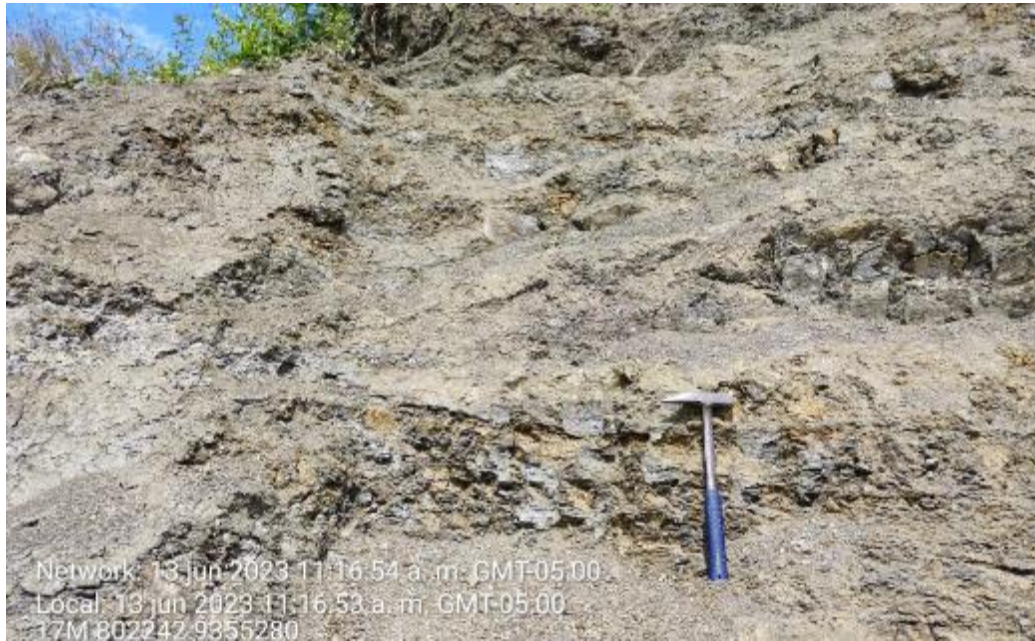
Fotografía 1. Macizo rocoso de lutitas calcáreas y calizas arenosas muy fracturadas y altamente meteorizadas de la Formación Celendín en la localidad de Puerto Naranjitos. Ubicación: E: 802242, N: 9355280.
