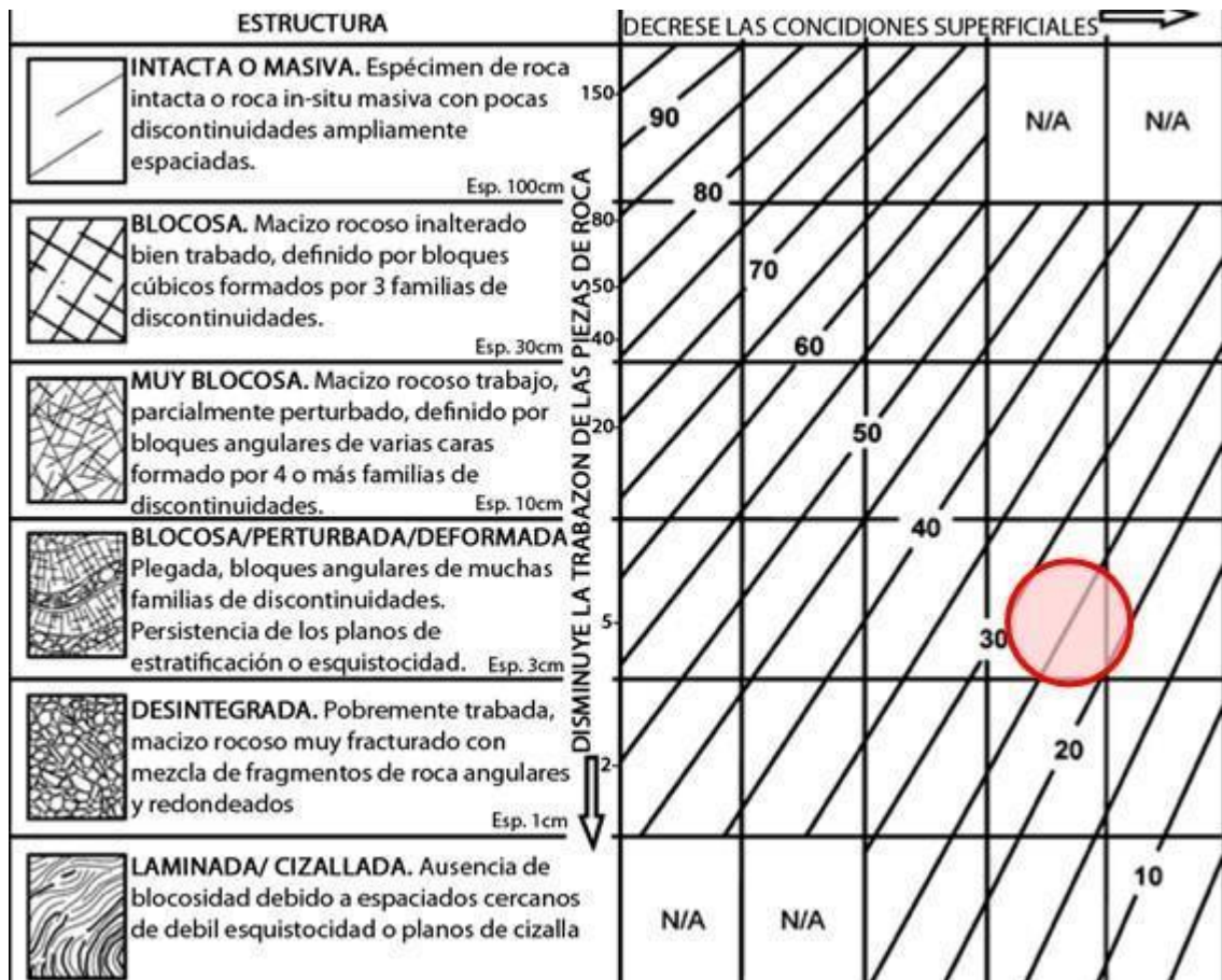
Figura 6. Estructura y calidad de las discontinuidades del macizo rocoso de la Formación Celendín, GSI promedio de entre 20 a 30. Fuente: Tabla del Índice Geológico de Resistencia GSI (Hoek, 2007).
