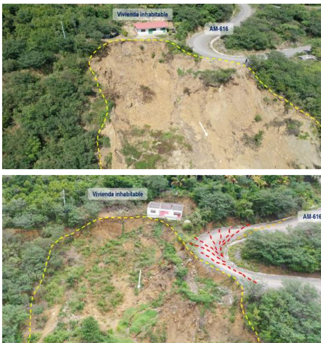
Figura 12. Estado del deslizamiento D-1 en Puerto Naranjitos los días 13/06/2023 (arriba) y el 28/04/2024 (abajo); el deslizamiento está delimitado en línea amarilla y los agrietamientos en línea roja.
