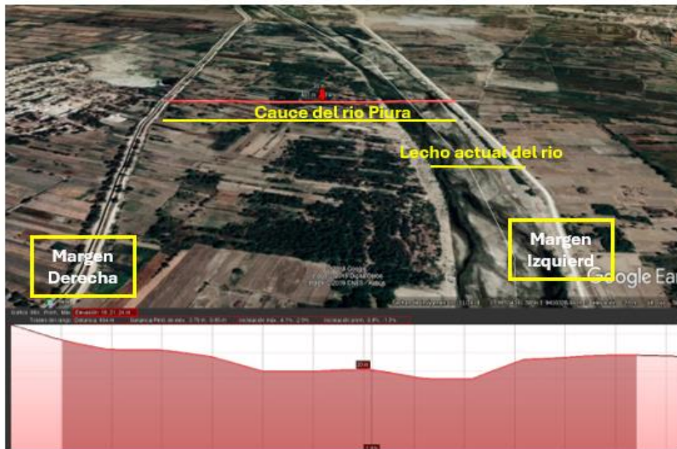
Gráfico N° 13: Relación de Cauce y lecho del río Piura en el tramo de Interés
