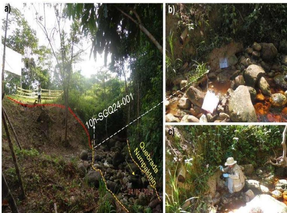
**Figura 8.31.** muestra de sedimentos. a) Ubicación de la muestra de sedimentos en la quebrada Numpaktain. b) Trampa hidráulica para la toma de muestra de sedimentos. C) Toma de muestra en frasco vidrio ámbar de 120 ml de boca ancha, para análisis químico por hidrocarburos totales.
