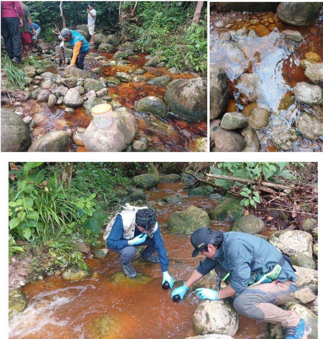
Figura 9.3. Toma de muestras de agua en el punto 2 para análisis químico (alcalinidad, metales totales y disueltos, aceites y grasas e hidrocarburos totales de petróleo).
