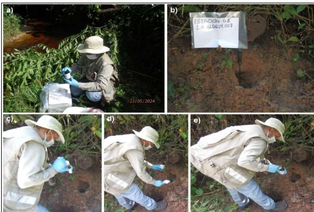
**Figura 8.5.** muestra de suelo superficial 10h-SLGQ24-007: a) Frasco de vidrio ámbar de 120 ml boca ancha. b) Profundidad de muestreo 0.30 cm. c) Toma de muestra en vial de vidrio de 40 ml para determinar la fracción de hidrocarburos. d) y e) Toma de muestra en frasco vidrio ámbar de 120 ml boca ancha, para material extraíble al hexano (aceites y grasas).
