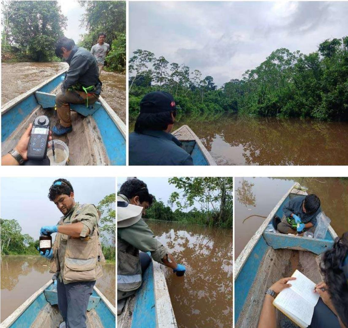
**Figura 9.4.** Toma de muestras de agua en el punto 3 para análisis químico (alcalinidad, aniones, metales totales y metales disueltos)
