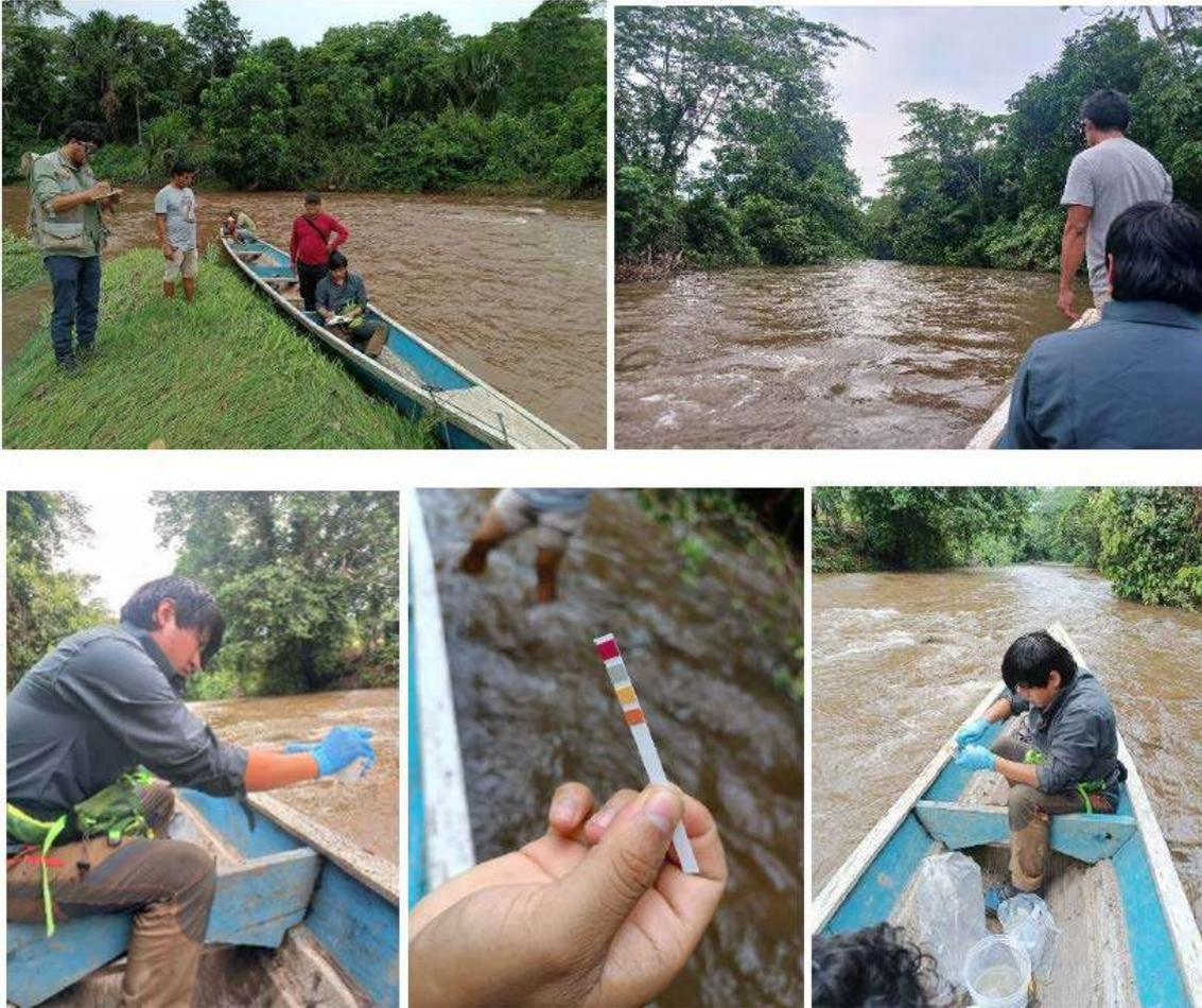
**Figura 9.5.** Toma de muestras de agua en el punto 2 para análisis químico (alcalinidad, metales totales y disueltos, aceites y grasas e hidrocarburos totales de petróleo).
