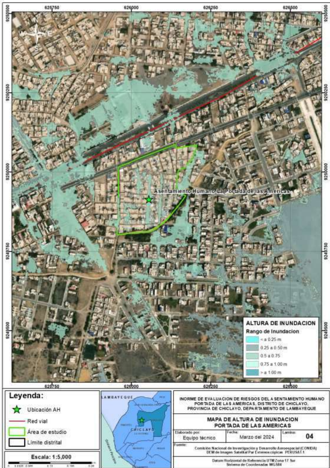
Mapa N°04: Mapa de Altura de Inundación en el Asentamiento Humano “La Portada de las Américas”
