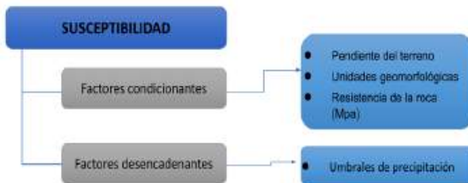
Figura 78. Determinación de la susceptibilidad por caída de rocas.
