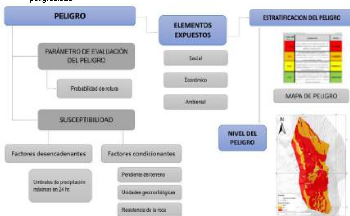
Figura 72. Flujoograma de la secuencia metodológica para determinación del nivel de peligrosidad.
