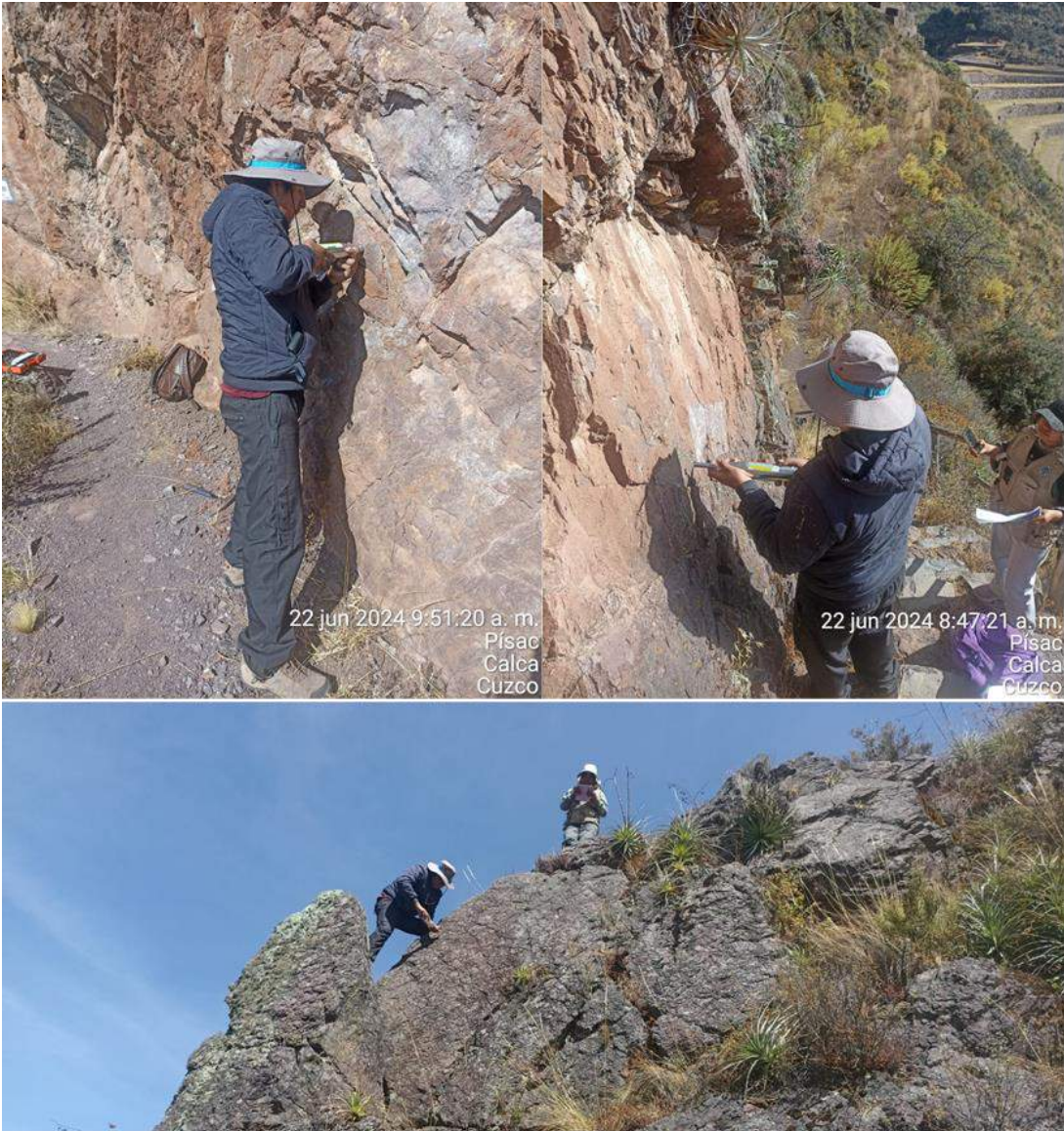
Figura 67. Medición de la resistencia de roca en diferentes puntos con Esclerómetro.
