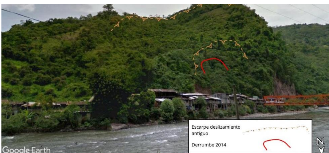
Figura 8. Ladera cercana al estribo sur del puente Paucartambo, mostrando rasgos de posibles deslizamientos antiguos. Foto Google Street View 2013.
