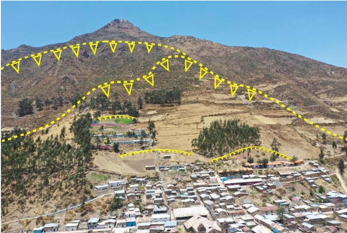
Figura 9. Vista panorámica de escarpes de deslizamientos antiguos (actualmente erosionados), sobre el cual se emplazó el poblado de Querco. Las líneas entrecortadas amarillas delimitan dicho deslizamiento y las líneas continuas muestran las reactivaciones recientes.
