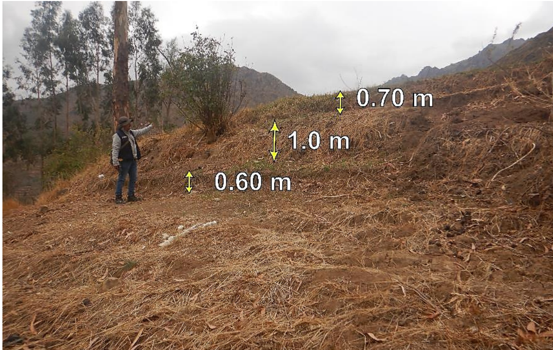
Figura 13. Desniveles en el terreno entre 0.60 m a 1.0 m, con un vector de movimiento hacia el suroeste. Coordenadas referenciales UTM WGS-84, 18S: E: 502612; N: 8454730.
