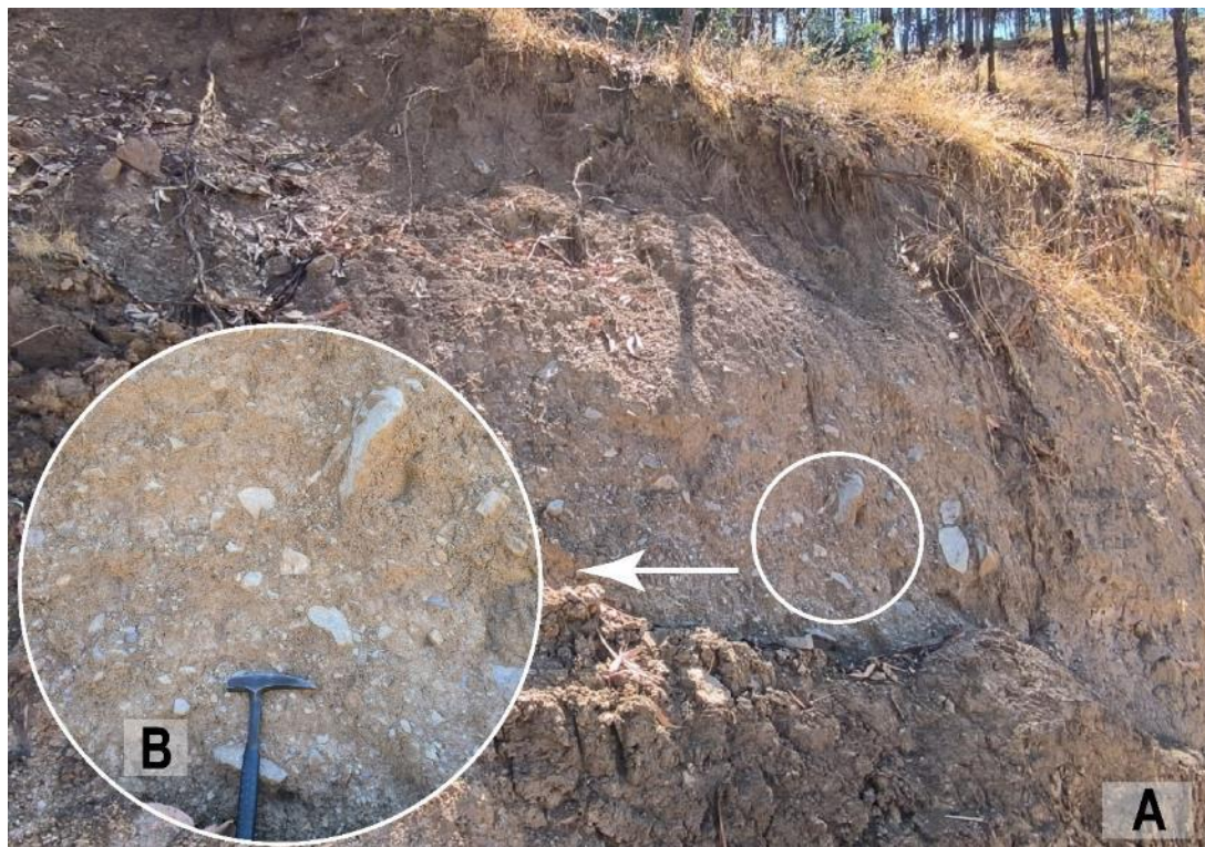
Figura 6. A. Vista de depósitos coluvio-deluvial (Q-cd), formando por fragmentos líticos, angulosos a subangulosos, heterométricos, medianamente consolidados. B. Detalle de los fragmentos líticos con diámetros visibles entre 0.02 a 0.20 m envueltos en una matriz areno-arcilloso.
