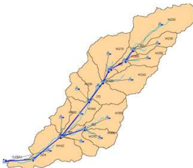
Figura 14: Esquema topológico del modelo en HEC HMS
