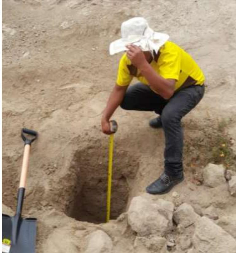
*Figura 56. Medición de la profundidad de la calicata en el lecho natural de la Quebrada Malanche – Punta Hermosa.*
