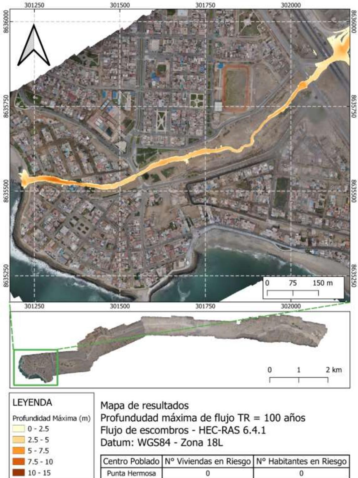
Figura 22: Profundidad máxima del flujo de escombros para TR de 100 años Área 1 ( $Q_{max}=77.9 \text{ m}^3/\text{s}$ )
