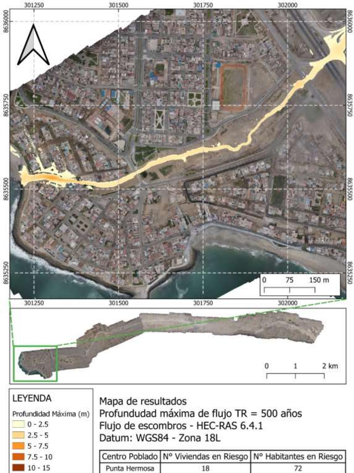
Figura 23: Profundidad máxima del flujo de escombros para TR de 500 años Área 1 ( $Q_{max}=151.3 \text{ m}^3/\text{s}$ )
