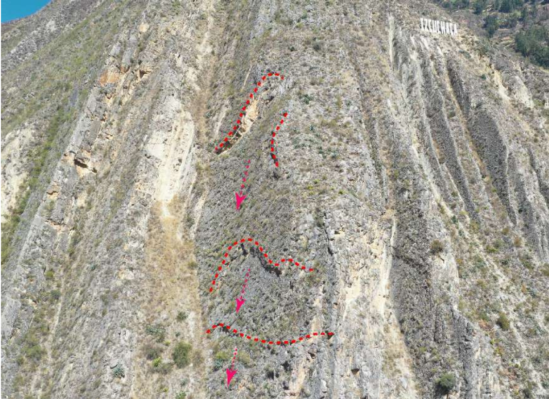
Figura 15. Evidencias de cicatrices de desprendimientos antiguos (líneas entrecortadas roja) que sugieren roturas planares con movimiento a favor del plano de estratificación.
