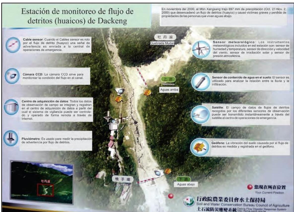
Figura 28. Estación de monitoreo de flujo de detritos (fotografía tomada de Soil and Water Conservation Bureau SWCB-Taiwan, por Vílchez, 2010).
