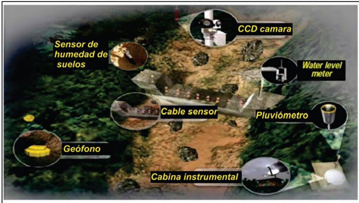
Figura 27. Sensores utilizados para el monitoreo de flujos de detritos (fotografía tomada de Soil and Water Conservation Bureau SWCB-Taiwan, por Vílchez, 2010).
