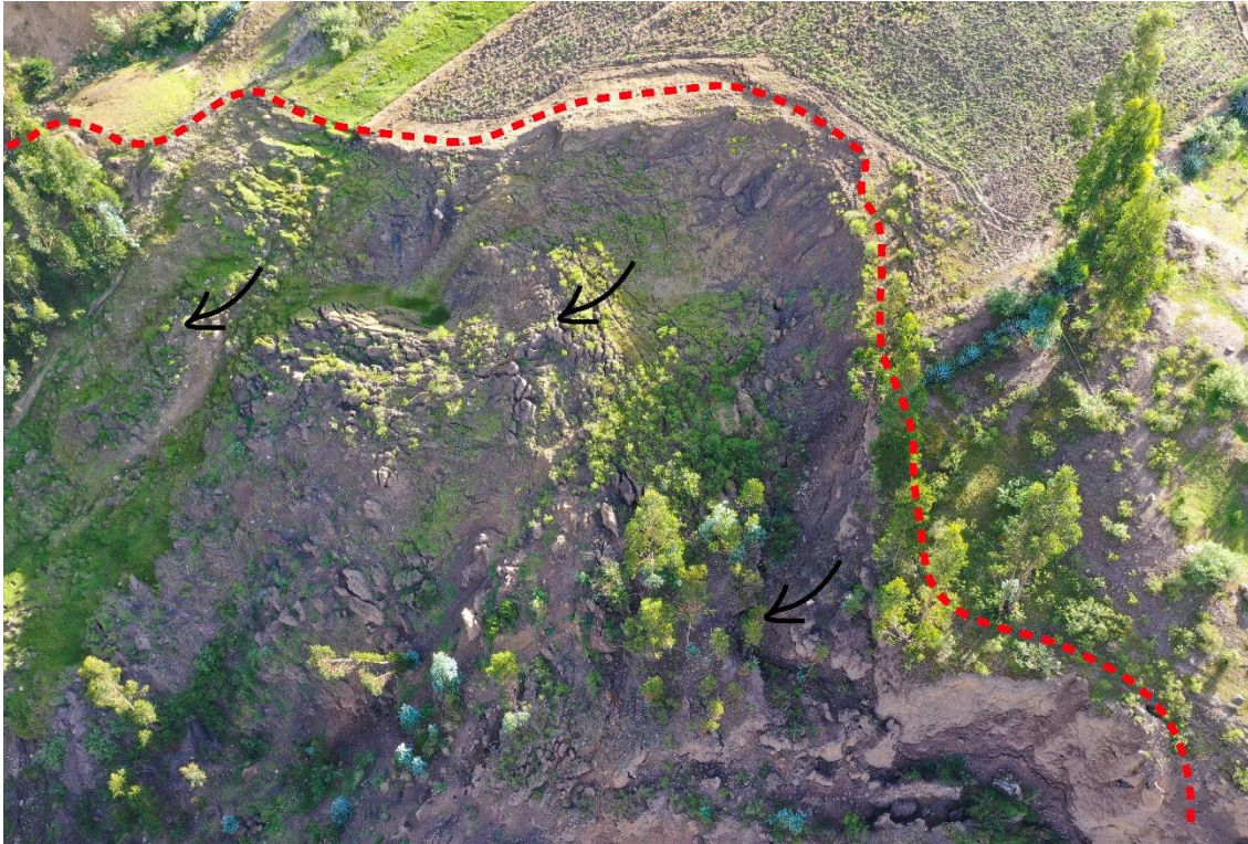
Figura 8. Vista aérea del deslizamiento rotacional; la línea roja punteada refleja la corona del deslizamiento, el salto del escarpe comprende alturas desde 5 m hasta los 15 m y una longitud aproximada horizontal de 500 m.
