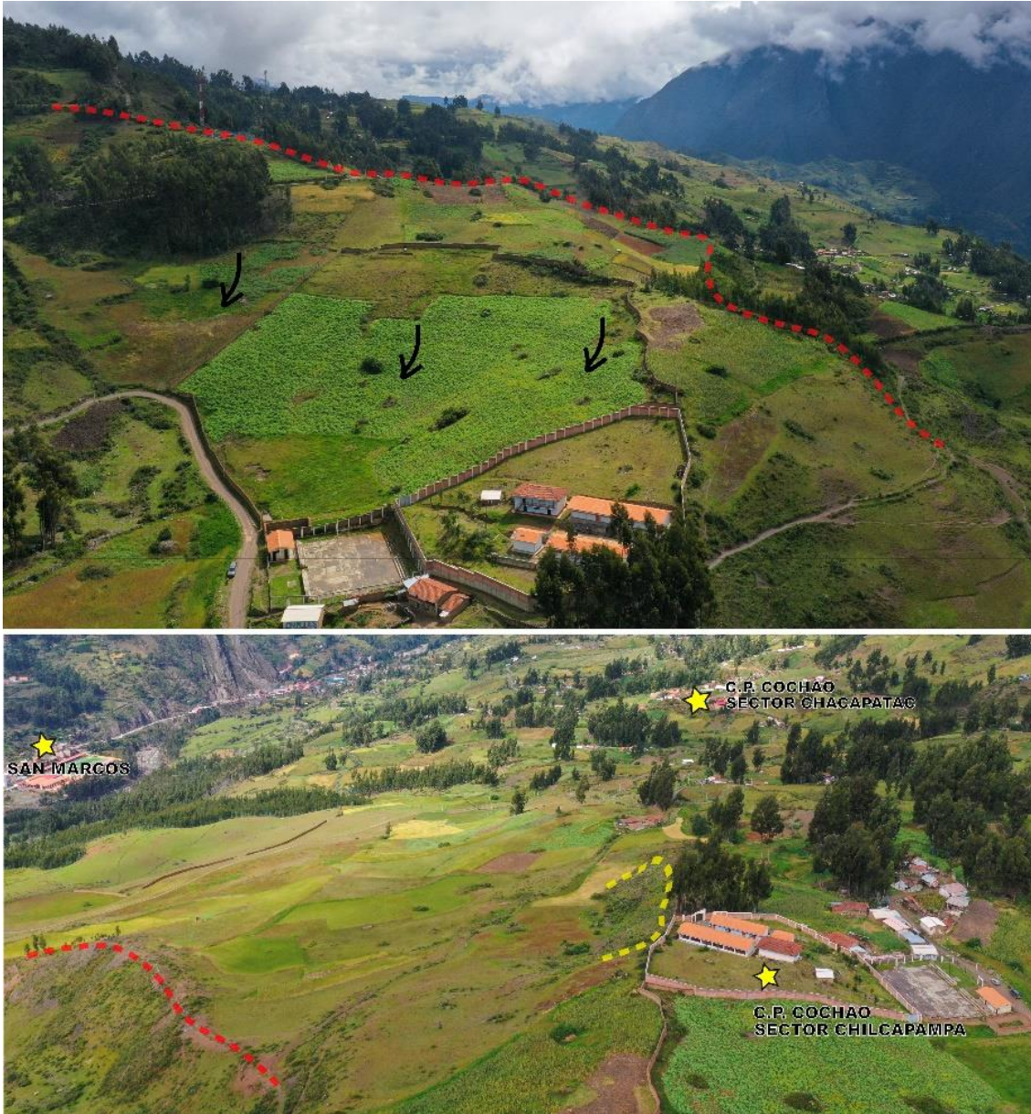
Figura 12. Vista aérea del sector Chilcapampa, la foto superior muestra ladera arriba, delineado de color rojo los flancos del deslizamiento y la foto inferior muestra ladera abajo, de color amarillo el borde de derrumbes.
