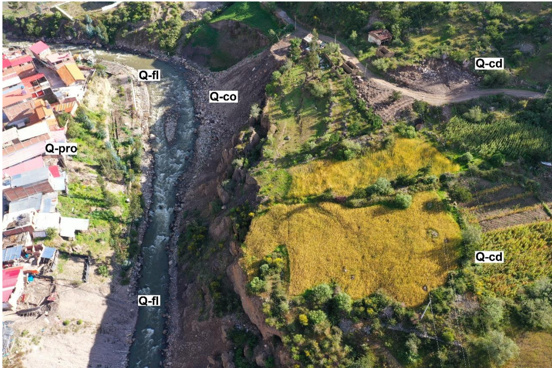
Figuraa 4. Vista aérea del centro poblado Cochao que está ubicado sobre un depósito coluvio-deluvial.
