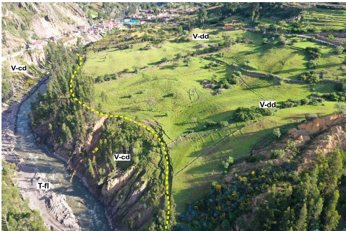
Figura 7. Vista con dirección al N, donde se observan unidades geomorfológicas de tipo vertientes con depósito de deslizamiento, vertientes coluvio-deluviales y terraza fluvial.
