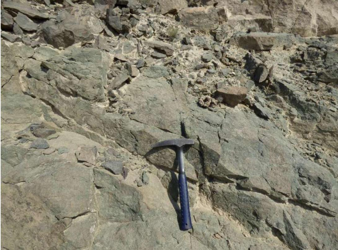
**Fotografía 4.** Se observan los afloramientos de la Formación Quilmana – unidad volcánica sedimentaria (Andesitas) en las coordenadas UTM, WGS 84, 18s, X:433085; Y: 8443430.
