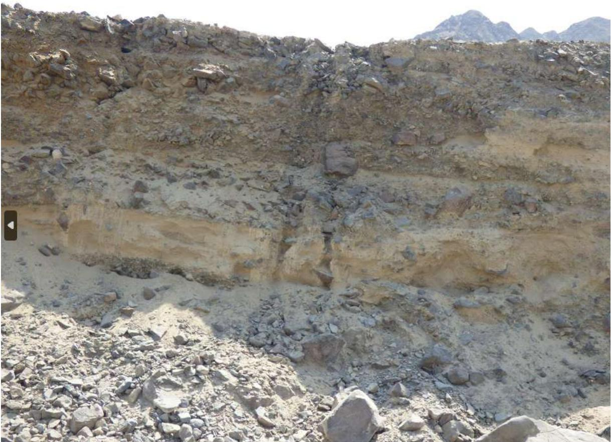
Fotografía 8. Depósitos proluviales, conformado por gravas y bloques de hasta 0.5 m de longitud, envueltos en una matriz limo-arenosa, formando terrazas de hasta 1 m de altura.
