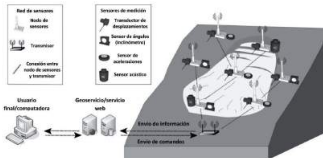
Figura 11.1. Esquema de un sistema de monitoreo de deslizamientos (tomado de Cordero & Espinoza, 2012).
