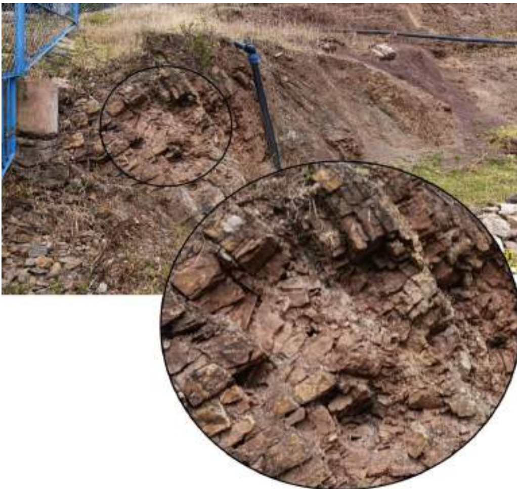
Figura 3.8. Areniscas con estratificación sesgada con espesores similares intercaladas con lutitas y limolitas correspondientes a la Fm. Chimú.
