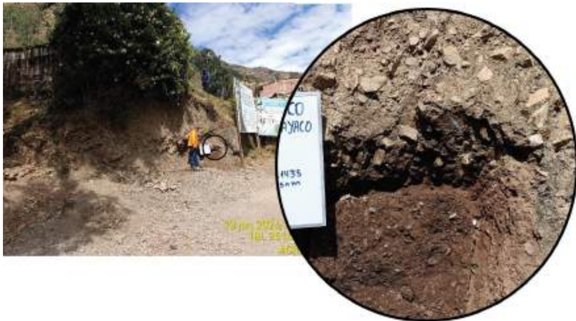
Figura 3.14. Depósito coluvio-deluvial 1, se observa fragmentos subangulosos envueltos en una matriz limosa.
