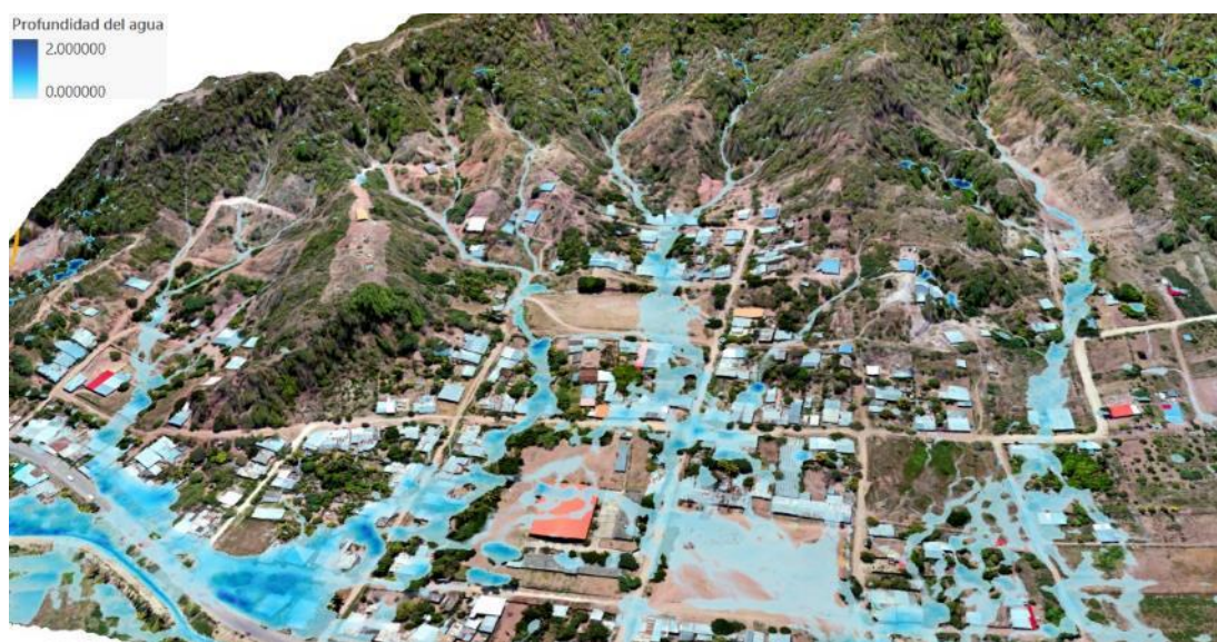
Figura 8. Simulación de un evento de lluvias intensas (80 mm/hora) en la localidad de Peca Palacios; indicando los sectores expuestos a afectación por flujos de lodo.
