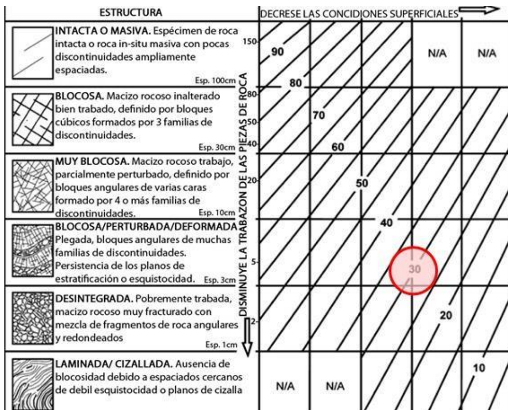
Figura 4. Estructura y calidad de las discontinuidades de los macizos rocosos de la Formación El Milagro, GSI promedio de entre 25 a 35 (en círculo rojo). Fuente: Tabla del Índice Geológico de Resistencia GSI (Hoek, 2007).
