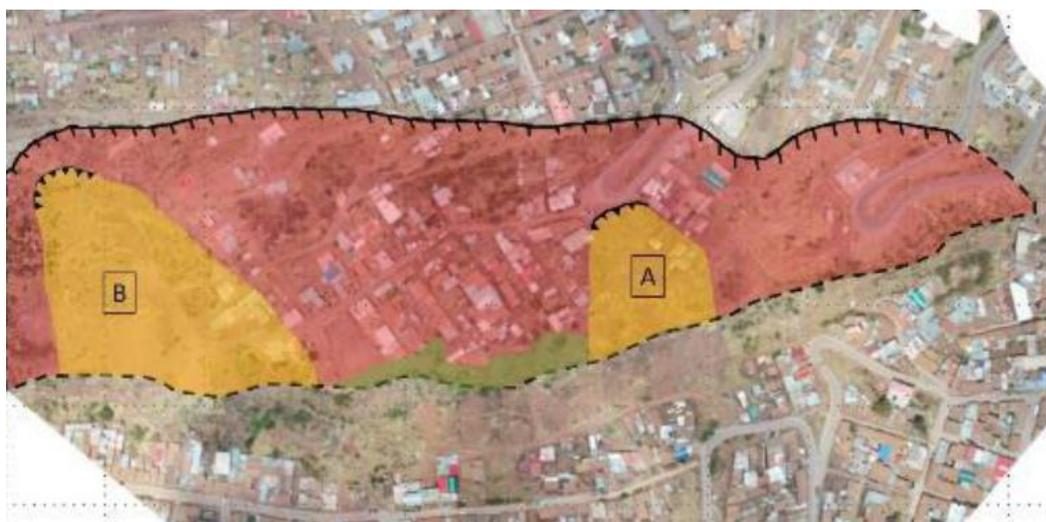
**Foto 13: Escarpes de deslizamientos activos en A.P.V. Alto San Martín y A.P.V Alto Cusco – INGEMMET - Informe Técnico N° A7451**
