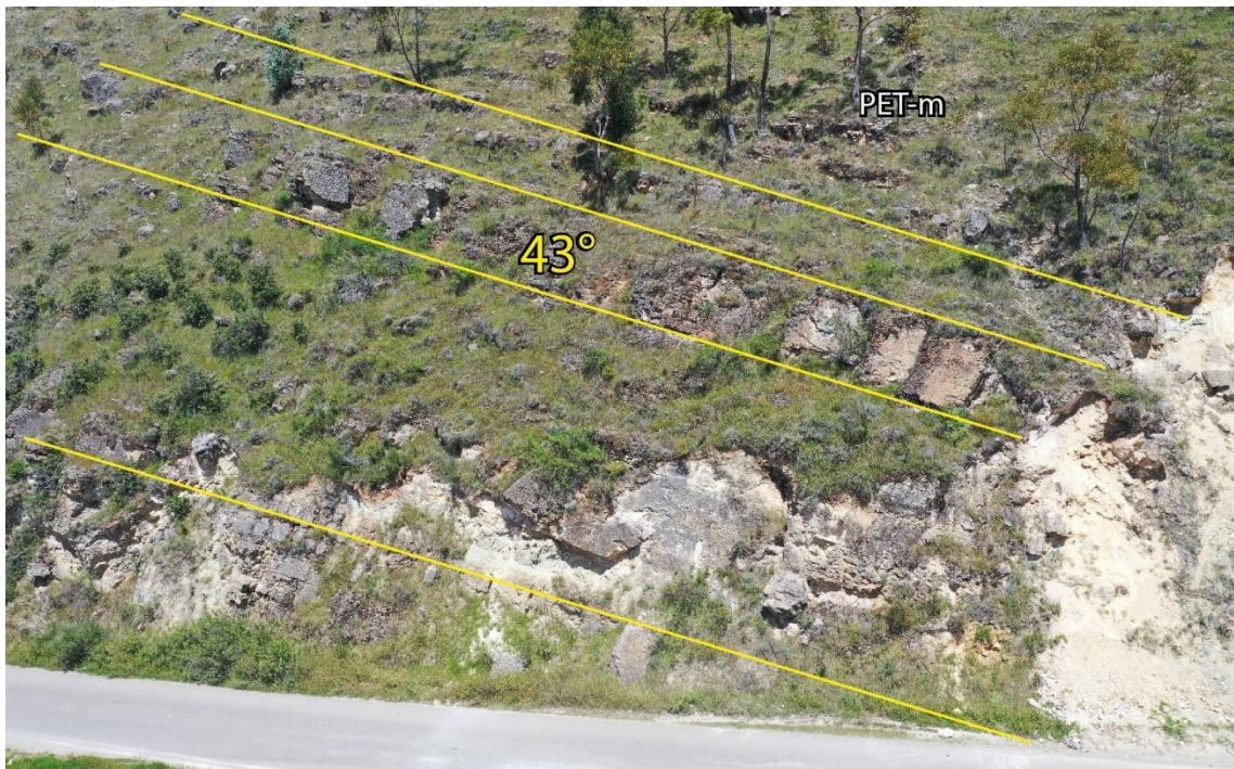
Figura 7: Muestra las unidades litoestratigráficas en el área de inspección y buzamientos de los estratos del Grupo Mitu. Coordenas WGS 84, 18s, X: 444054 m E; Y: 8702687.m S.
