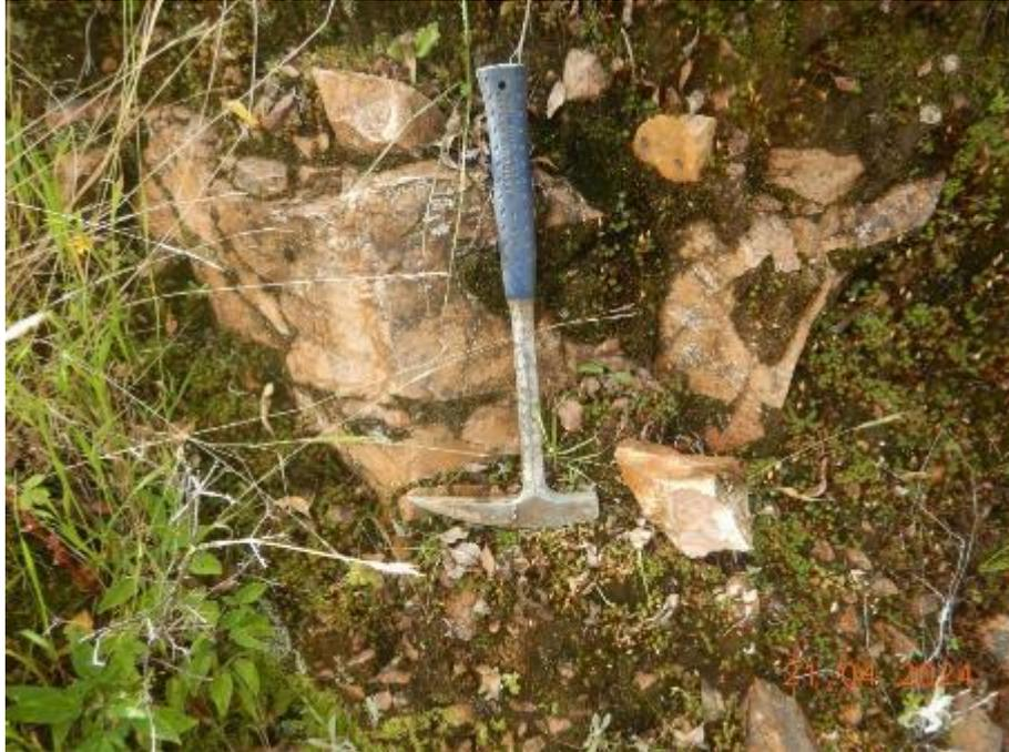
**Fotografía 2:** Depósitos coluvio-deluviales compuesto por bloques y gravas envueltas en matriz areno limosa.
