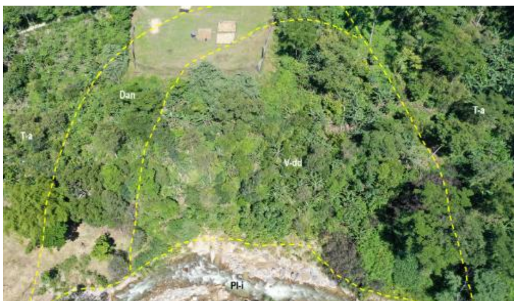
Figura 10. Vista de las geformas cartografiadas en la localidad de Lagunas: Terraza aluvial (T-a), depósito antrópico (Dan), vertiente con depósito de deslizamiento (V-dd) y planicie inundable (PI-i).
