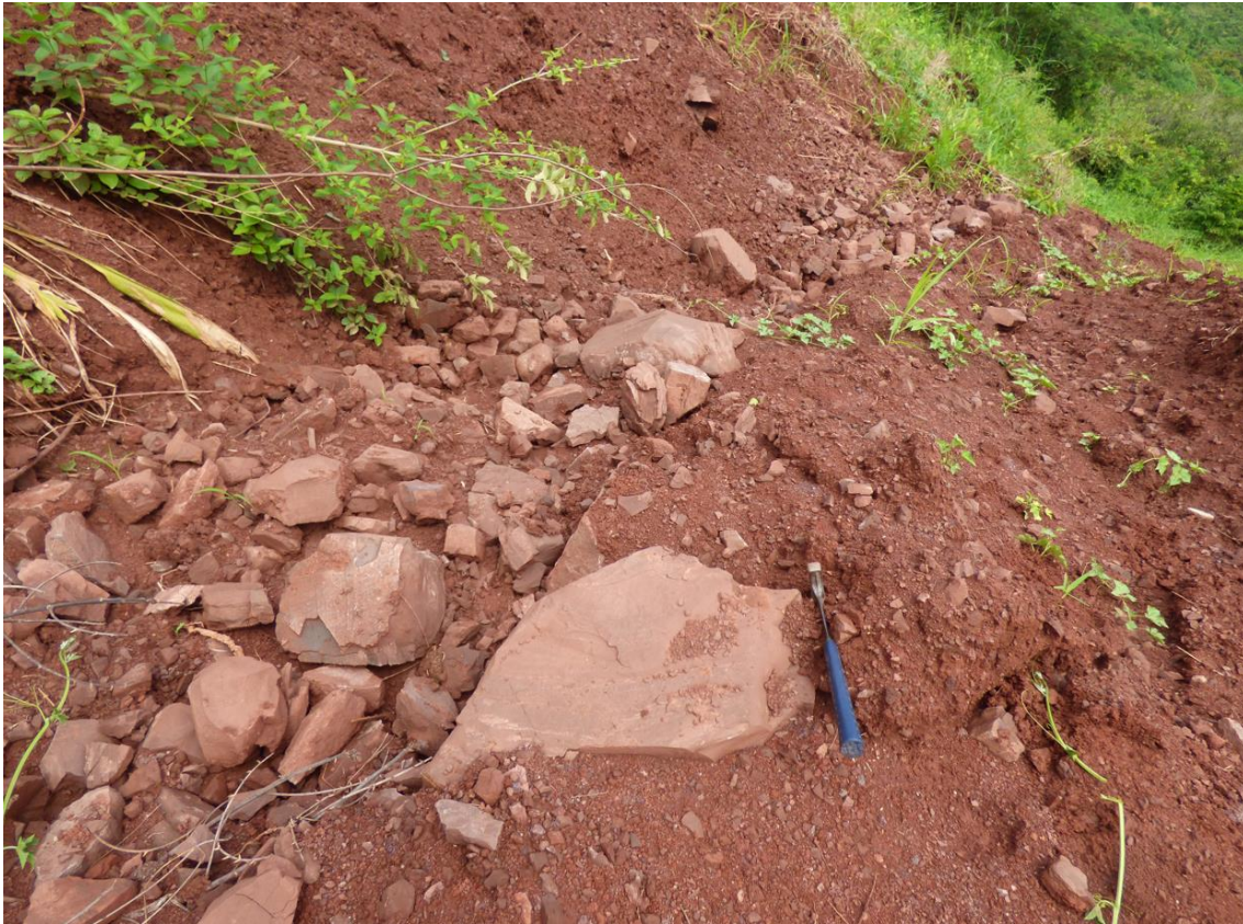
Fotografía 4. Muestra los componentes litológicos del cuerpo deslizado, bloques en una matriz limo arcillosa, suelta.
