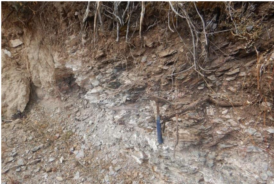
Fotografía 2. Vista de los esquistos, donde se puede observar el fracturamiento, que va desde muy fracturados hasta fragmentados. Coordenadas referenciales UTM WGS-84, 18S: E: 524942; N: 8622723.
