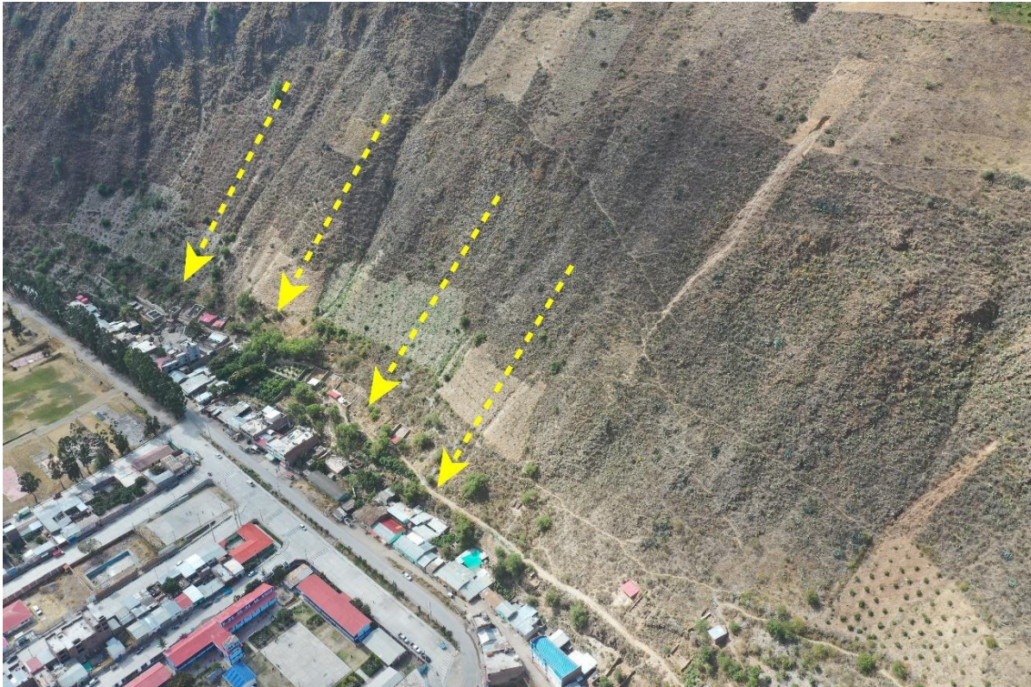
Figura 14. Zona susceptible a caída de rocas, y su posible dirección de desplazamiento, señalada en flechas entre cortadas amarillas.
