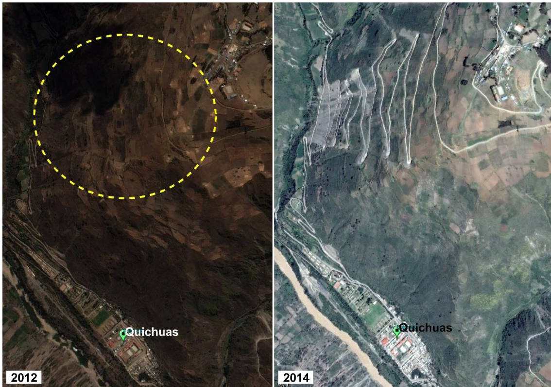
Figura 11. Comparación de dos imágenes satelitales izquierda (setiembre, 2012), derecha (enero, 2014), donde se muestra que la ladera presenta cortes de talud para la apertura de una vía de comunicación entre Quichuas y la hacienda Accoyanca.
