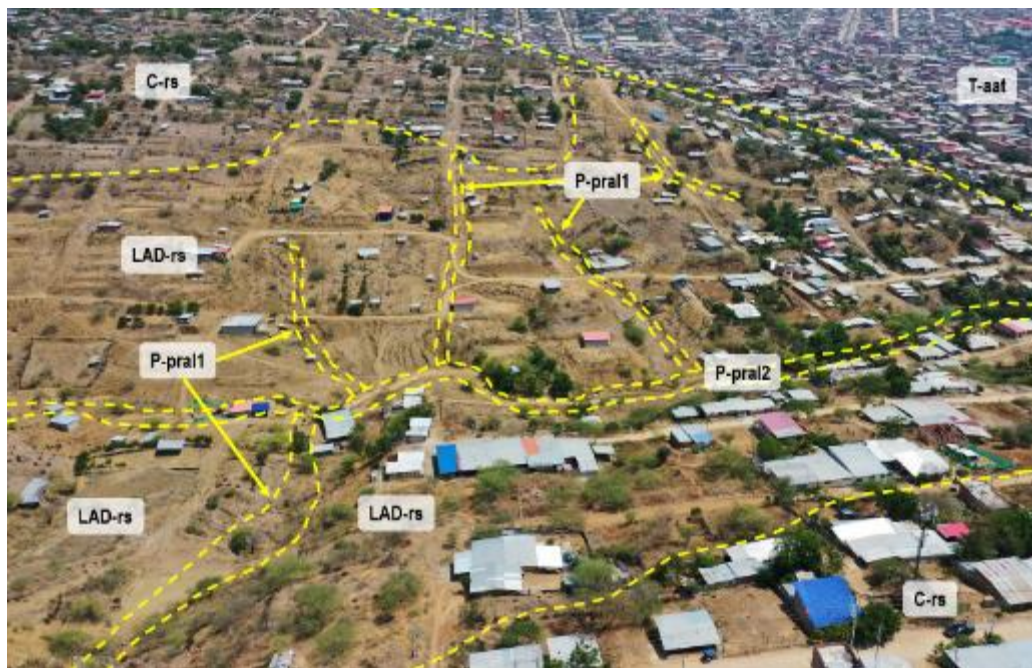
Figura 8. Geoformas cartografiadas en los sectores La Esperanza y San Martín de Porres: colina en roca sedimentaria (C-rs), ladera disectada en roca sedimentaria (LAD-rs), piedemonte proluvial 1 (P-pral1), piedemonte proluvial 2 (P-pral2), y terraza aluvial antropizada (T-aat).
