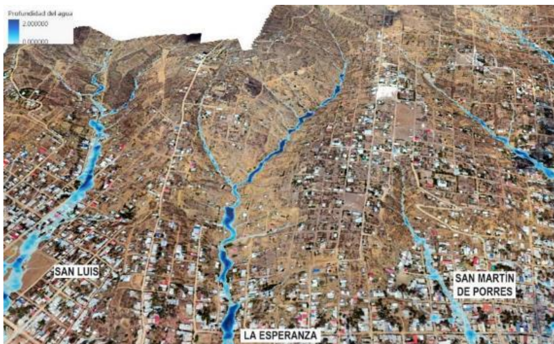
Figura 9. Simulación de un evento de lluvias intensas (80 mm/hora) en los sectores de San Martín de Porres, La Esperanza y San Luis.
