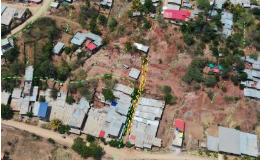
Figura 11. Peligros geológicos en el sector La Esperanza: se delimitan los procesos de erosión en surcos (verde) y erosión en cárcavas (amarillo).
