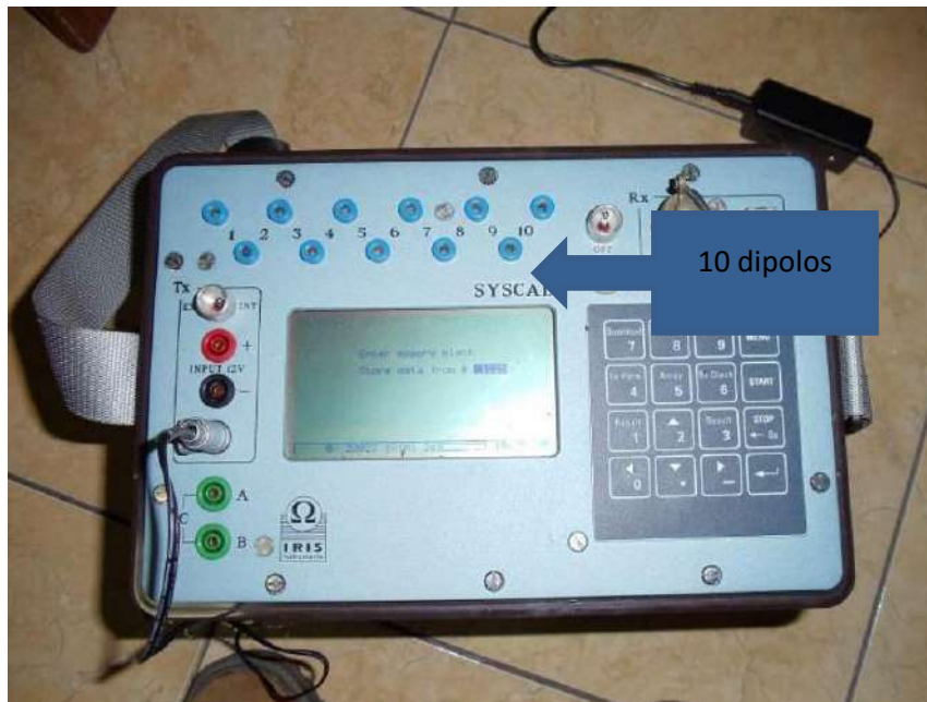
Figura 9. Equipo de Tomografía Eléctrica Syscal Pro Switch 48 con 10 dipolos.
