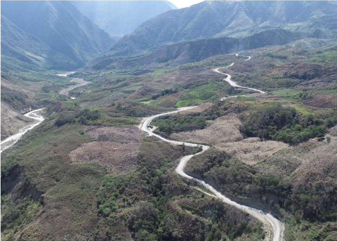
Fotografía 2. Vista de las subunidades geomorfológica en la parte inferior del deslizamiento Aserradero, margen izquierda del río Utcubamba: relieve de montaña en roca sedimentaria (M-rs) y piedemonte coluvial (P-c). Tomada mirando aguas arriba. UTM: 813386 / 9347736, Zona 18.
