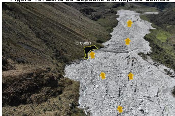
Fuente: INAIGEM (2025). *Nota.* La figura muestra la zona de depósito del flujo de detritos en la planicie aguas abajo de la zona de socavación. El polígono con perímetro en color amarillo muestra una zona de erosión causado por el impacto del flujo de detritos.
