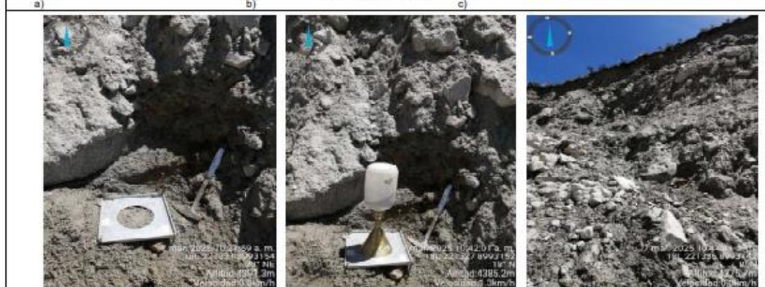
Fotografía: a) Preparación del suelo para la realización del ensayo in situ, b) Realización del ensayo de densidad, c) Vista de la morrena empleada en la margen izquierda del canal de salida de la laguna Cancahua.
