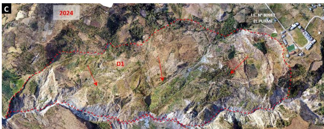
Figura13. Vista aérea del movimiento en masas, 2024. Delimitada con línea roja.
