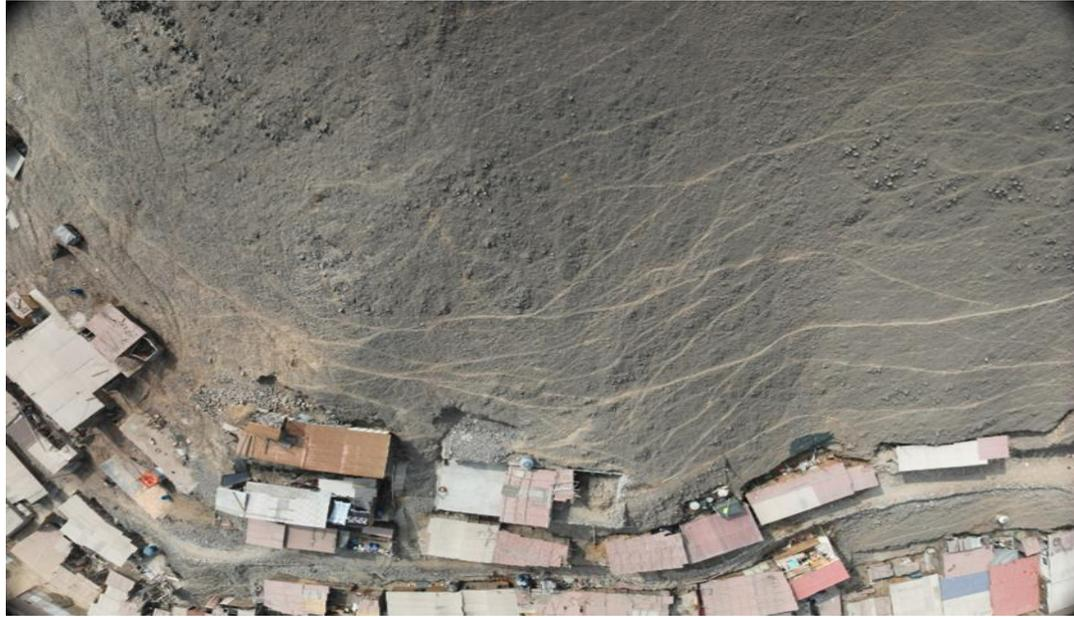
Vista con dron, se puede apreciar viviendas no cumplen con el reglamento de los parámetros urbanos, sin contar con una adecuada planificación para asentarse sobre las laderas arriba, así mismo carecen de muros de contención con no tienen accesibilidad para evacuar en caso de sismo, en diferencia con las viviendas que si tienen el acceso en laderas abajo.
