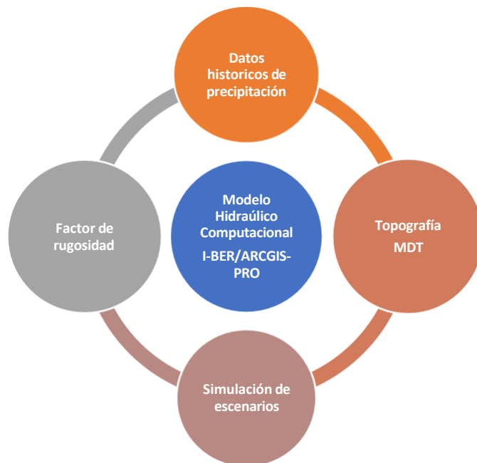
Figura N° 20. Diagrama de ingreso y salida de datos con el programa IBER y ArcGIS-PRO.
