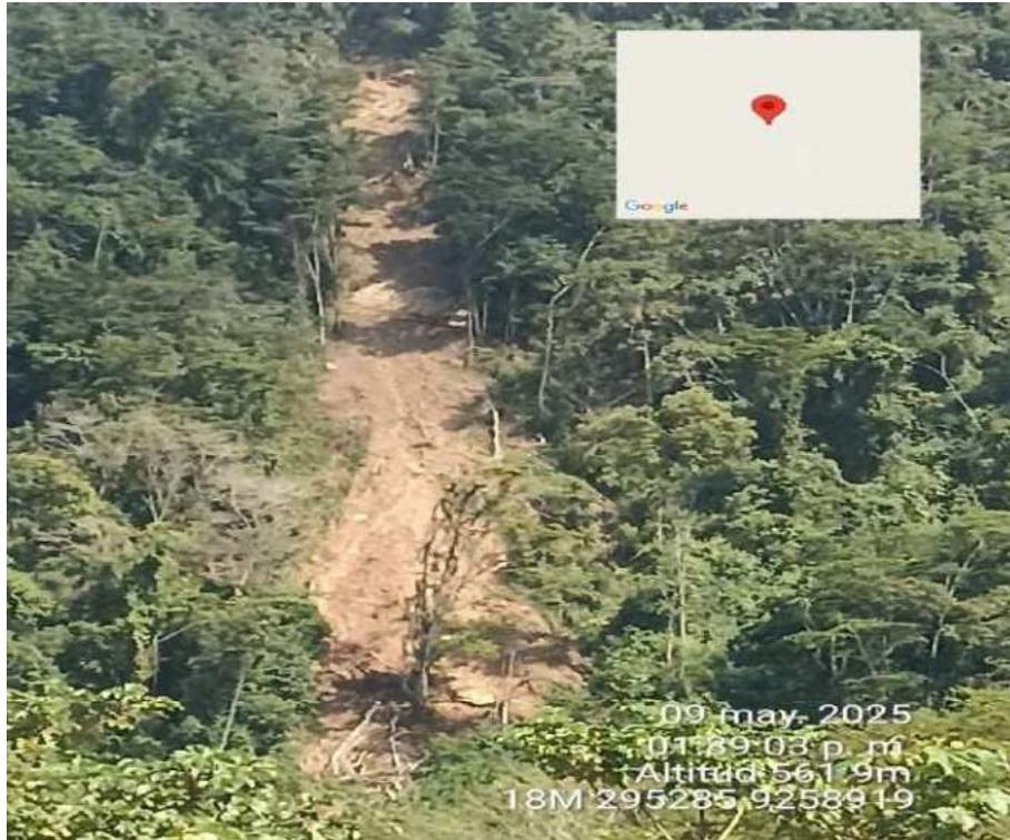
**Descripción:** Se muestra un deslizamiento reciente a unos 15 m hacia arriba en la margen izquierda de la carretera hacia Nueva Ilusión, el deslizamiento tiene una longitud de aproximadamente 80 metros, el cual se evidencia que está avanzando y puede llegar a afectar a la carretera existente.
