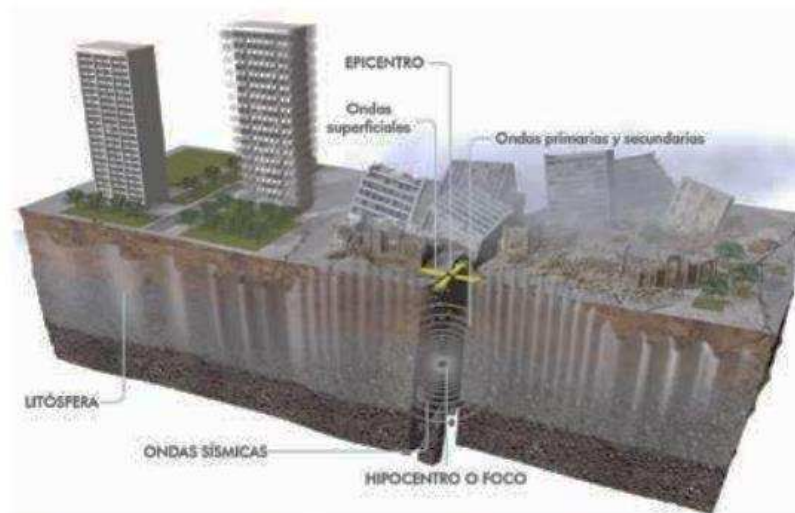
IMAGEN N° 24 Efectos de ondas sísmicas en edificaciones
