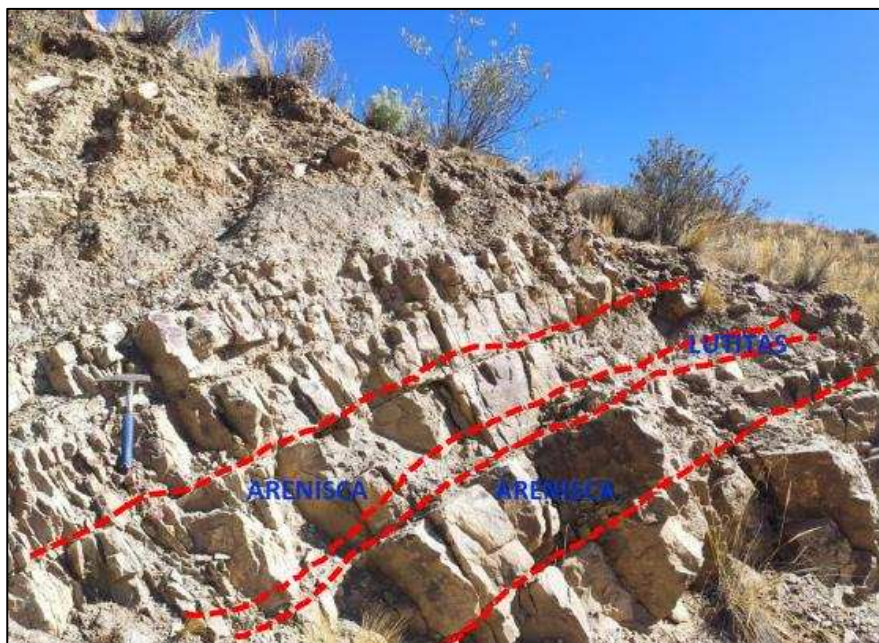
IMAGEN N° 8 Afloramientos de areniscas y lutitas muy fracturadas de La Formación Labra con UTM 8209,098- 318,670
