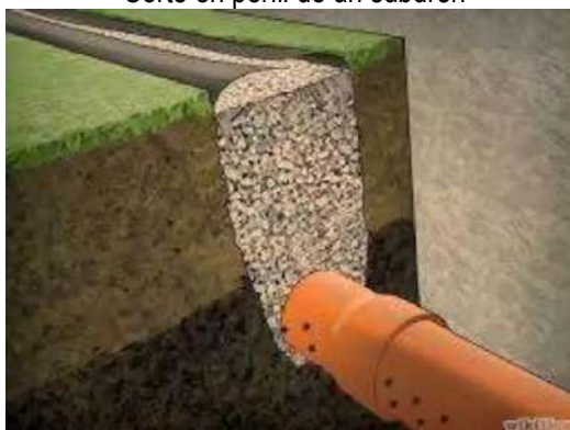
Corte en perfil de un subdren
