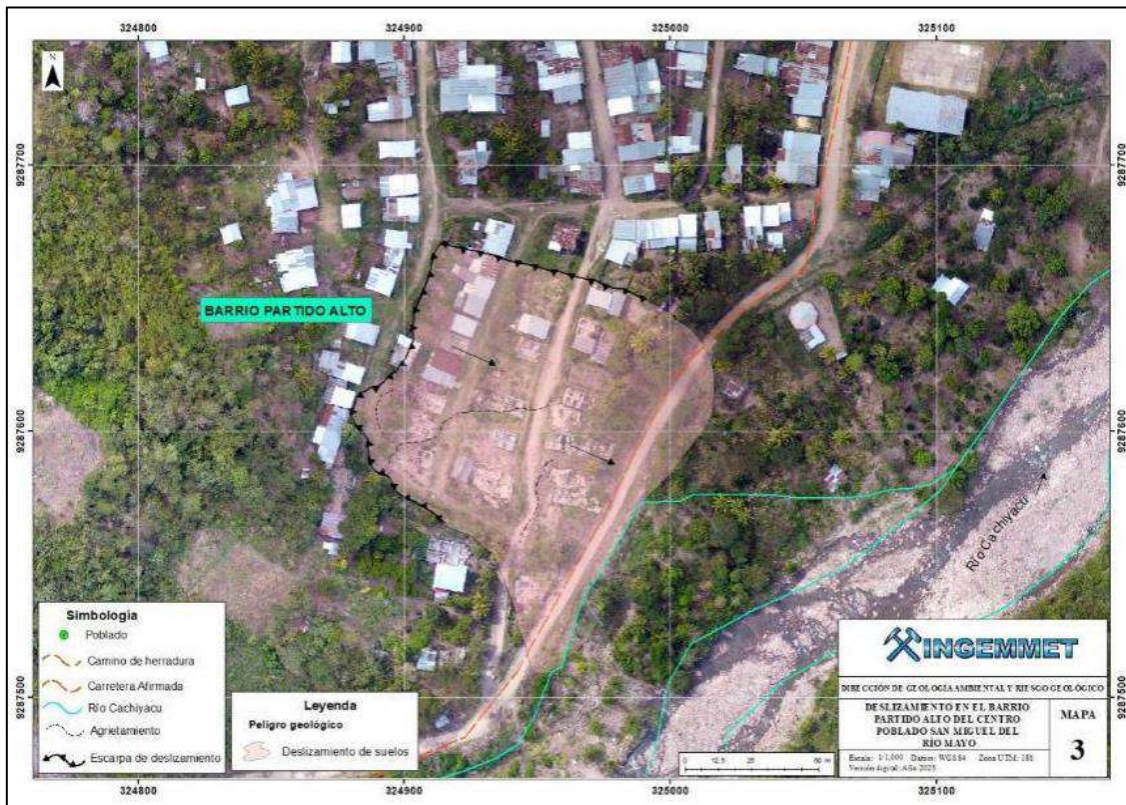
Ilustración N°30: Registro fotográfico del área de afectación del CCPP San Miguel del rio mayo por deslizamiento.
