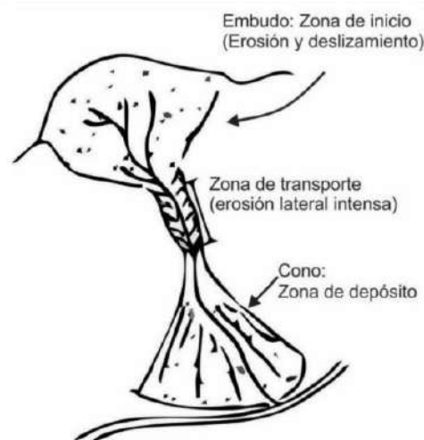
Figura N° 30: Esquema de generación de un flujo.
