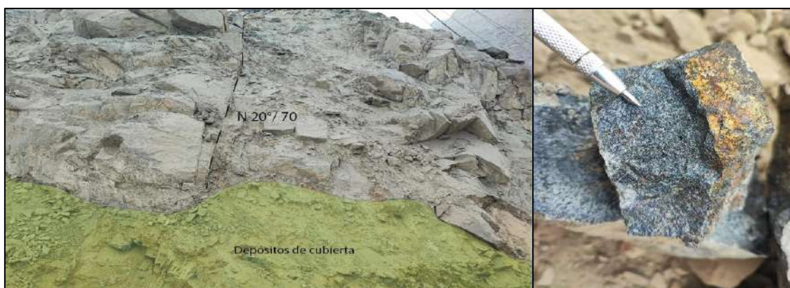
Figura 18. Izquierda; Vista de afloramiento con fuerte diaclasamiento. Derecha; vista de acercamiento de gabrodiorita con fracturas rellenas de óxidos.
