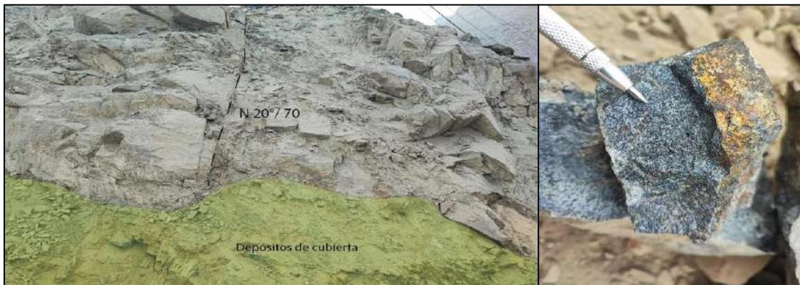
**Figura 20.** Izquierda; Vista de afloramiento con fuerte diaclasamiento. Derecha; vista de acercamiento de gabrodiorita con fracturas rellenas de óxidos.
