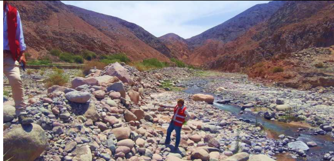
La imagen muestra la parte inicial del área de estudio para alta del río Huaracane, así mismo al margen izquierdo de la foto el lecho fluvial presenta material de gravas y bloques de rocas que superan fácilmente el metro de diámetro que se presenta a manera de cause descolmatado.
