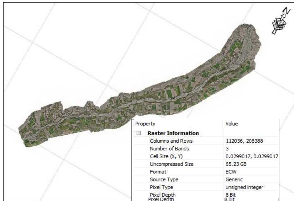
Figura N° 1: Ortofoto para modelamiento hidráulico
