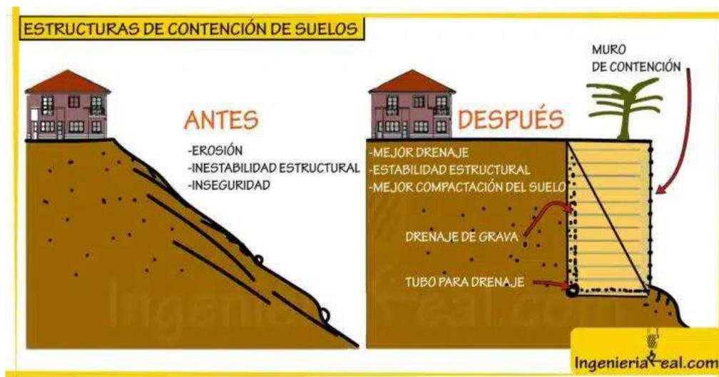
Se proyecta la construcción de muros de contención de alturas variables dependiendo de la configuración topográfica, en general las alturas no debieran exceder los 5 m.
