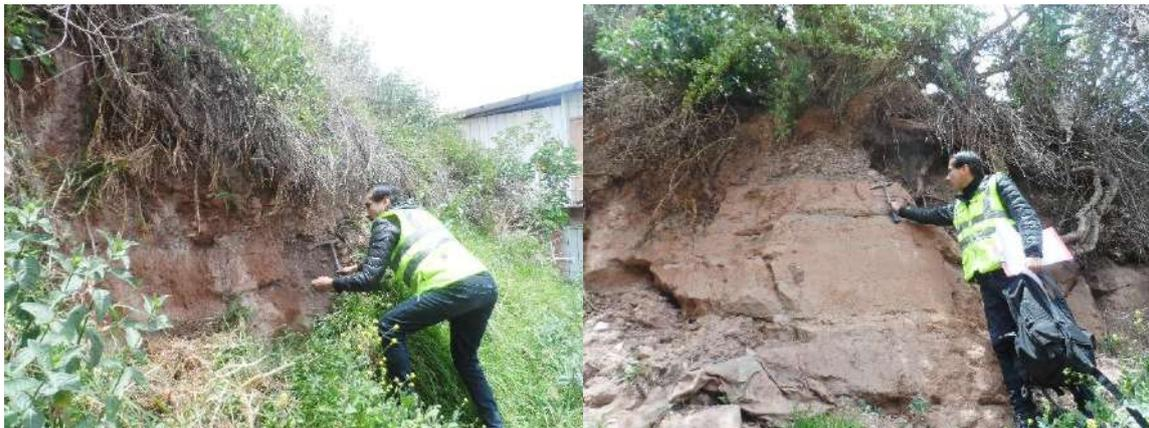
Foto 6: Vista del material arena arcillosa con gravas arenosas la cual estaría evidenciándose que por el tipo de material la inestabilidad del talud en dicho sector antes mencionado (foto 4)
