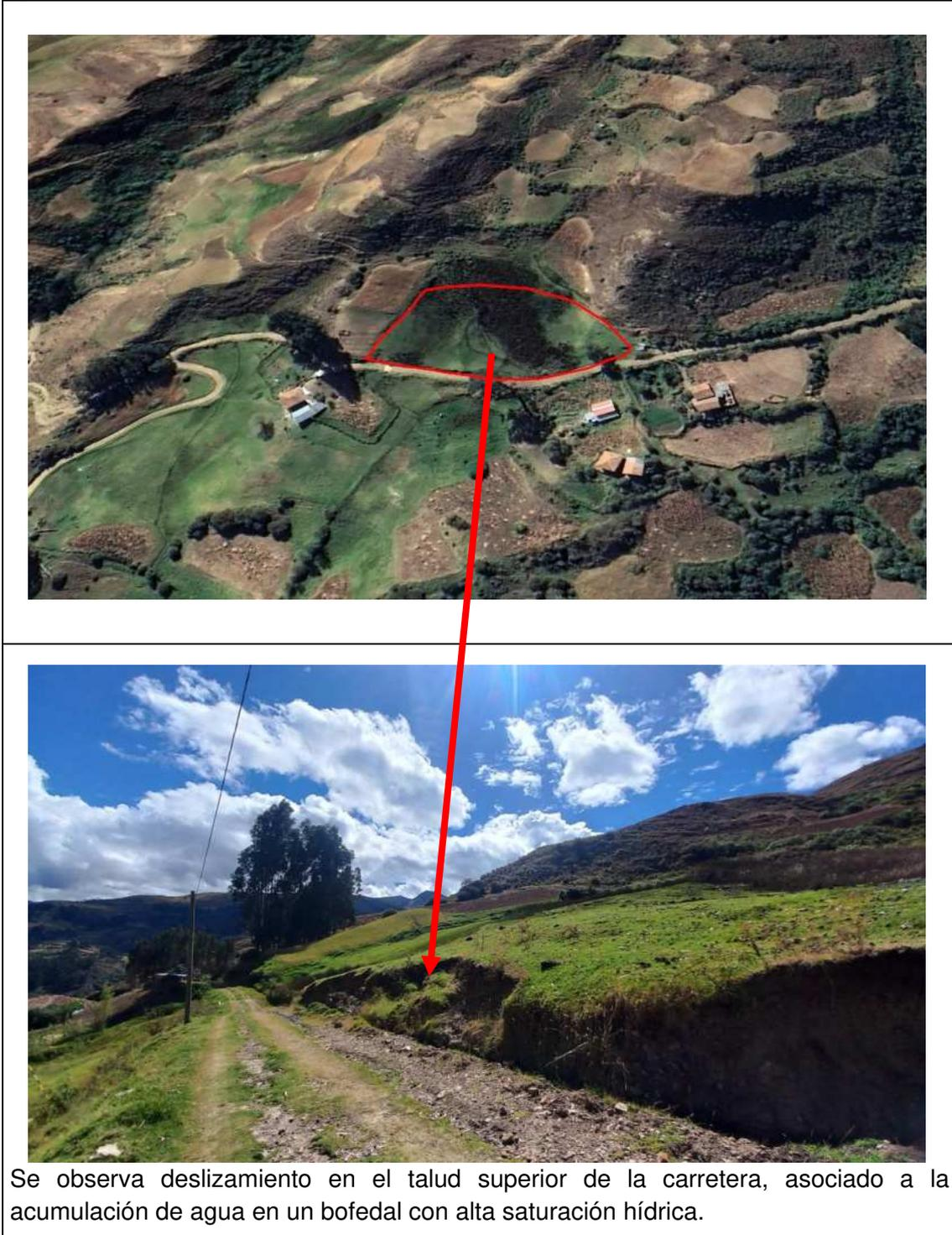
Se observa deslizamiento en el talud superior de la carretera, asociado a la acumulación de agua en un bofedal con alta saturación hídrica.
