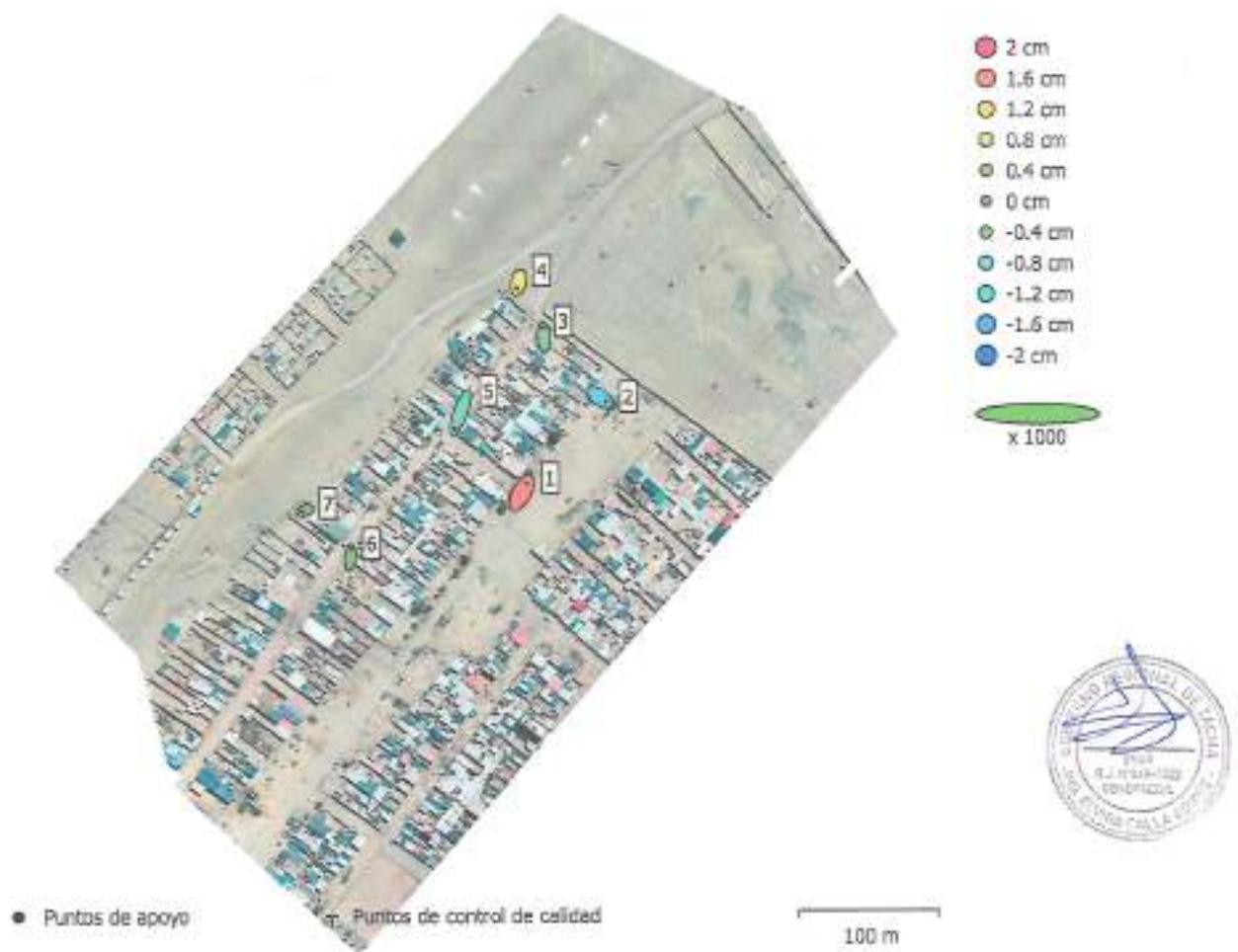
Fig. 3. Posiciones de puntos de apoyo y estimaciones de errores.
