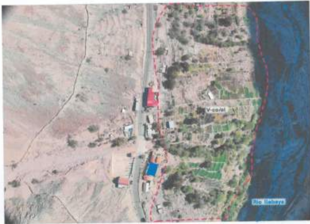
Fotografía 47 Vista de las vertientes Coluvio-aluvial (V-co(al), que se ubica debajo de la via a Borogueña, con pendientes mayores a 15°.
